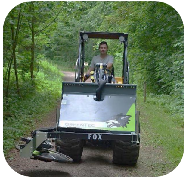
FOX-Multiträger montiert mit RI-80 Zaunmäher in Transportstellung. Für maximale Verkehrssicherheit zeigt das Anbaugerät nach innen zum Fahrzeug.
