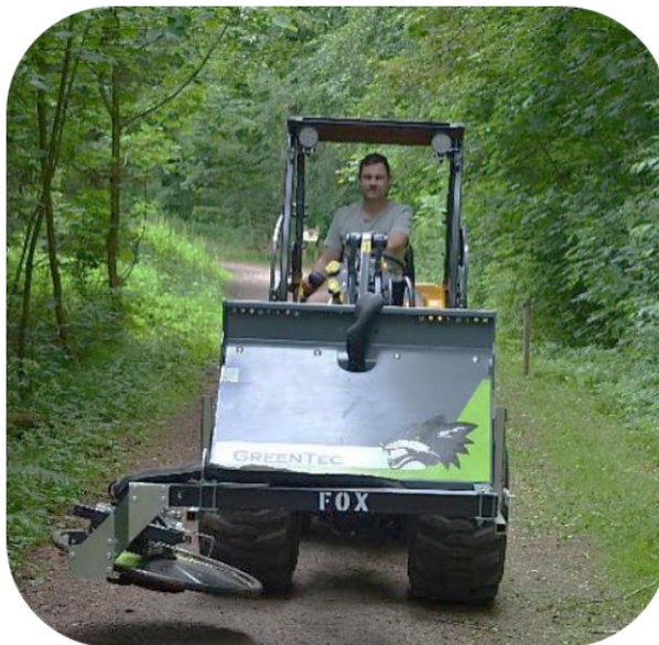
FOX-Multiträger montiert mit RI-80 Zaunmäher in Transportstellung. Für maximale Verkehrssicherheit zeigt das Anbaugerät nach innen zum Fahrzeug.
