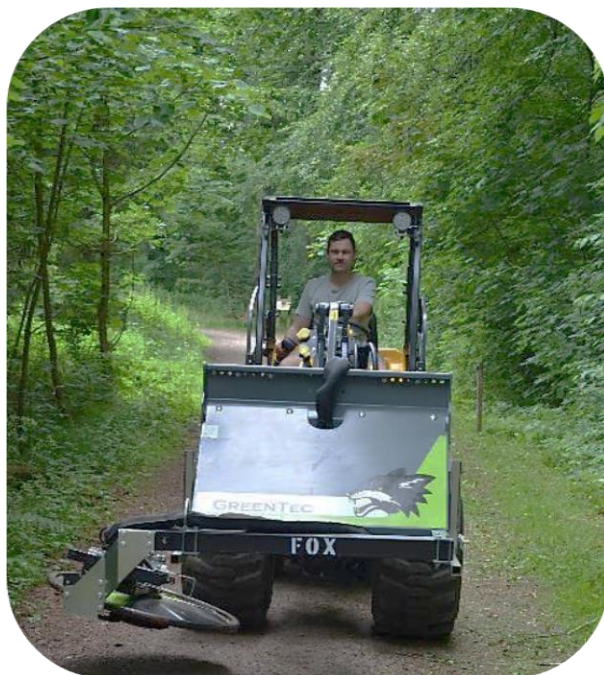
FOX redskabsramme monteret med RI-80 kantklipper i transportposition. Redskabet er vendt indad mod køretøjet, for maksimal trafiksikkerhed.
