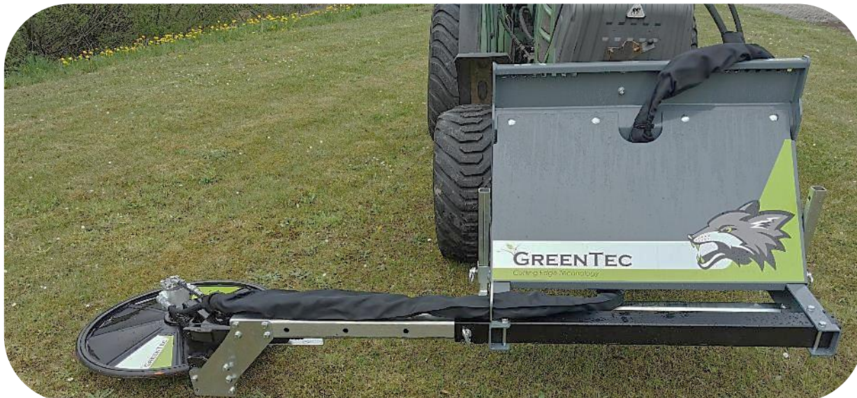
GreenTec FOX Redskabsramme monteret på mindre traktor.
