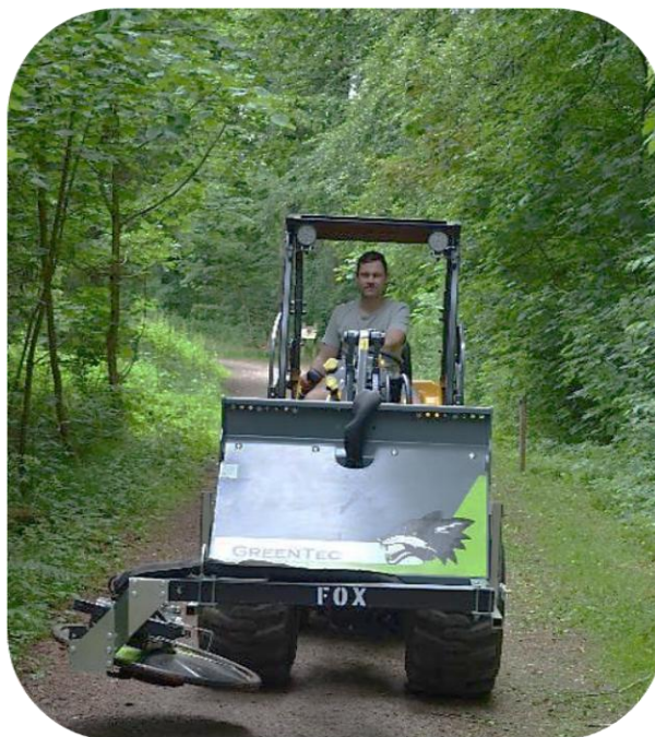
FOX redskabsramme monteret med RI-82 kantklipper i transportposition. Redskabet er vendt indad mod køretøjet, for maksimal trafiksikkerhed.
