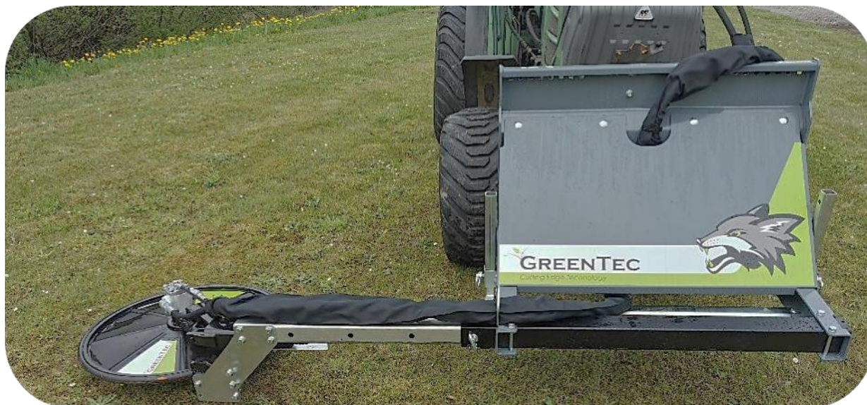
Porte-outil FOX de GreenTec monté sur un petit tracteur.
