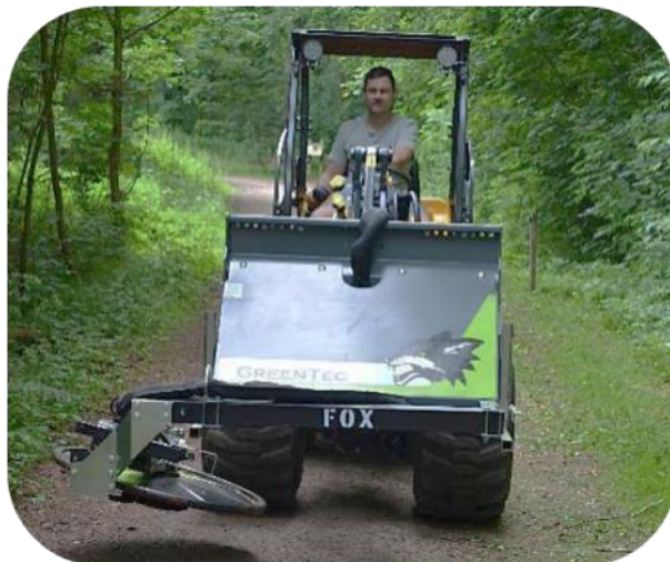
Porte-outil FOX avec faucheur sous clôture RI-80 en position de transport. Le faucheur sous clôture est orienté vers l'intérieur du véhicule, pour une sécurité maximale en conditions de circulation.
