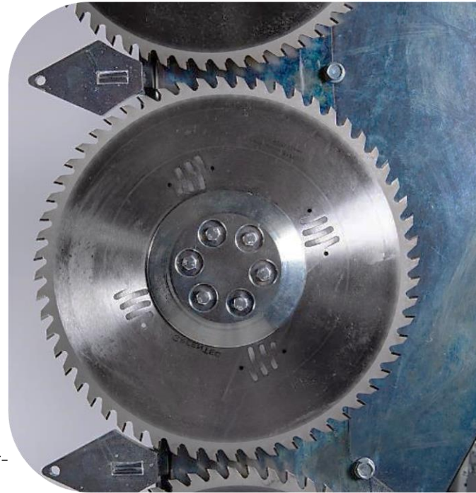
Sägeblätter mit Widia-Zähnen
