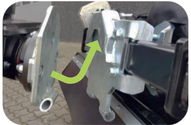
Beispiel: Der mechanische Schnellwechseladapter „männlich“ vom Auslegemulcher wird mit dem Adapter „weiblich“ am Anbaugerät gepaart
