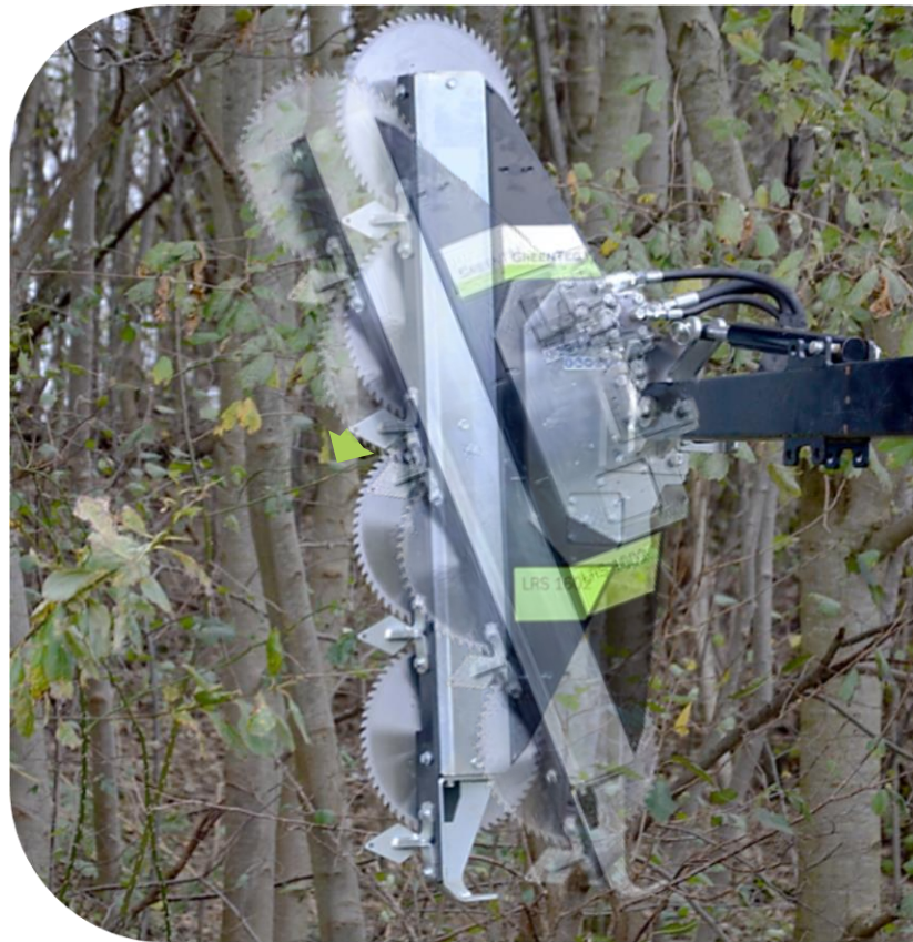
Schnittwinkelseinstellung an der LRS 1602 Astsäge, montiert auf dem PUMA 2803-Multiträger
