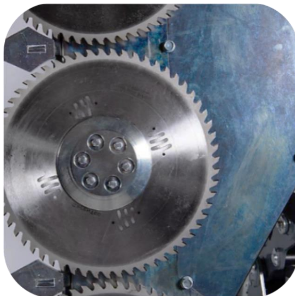
Sägeblätter sind mit Korrosionsschutz-Öl beschichtet
