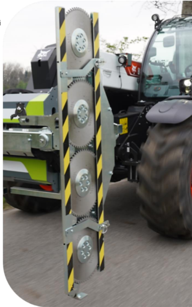
Um die Sägeblätter herum montierter Schutzschirm
