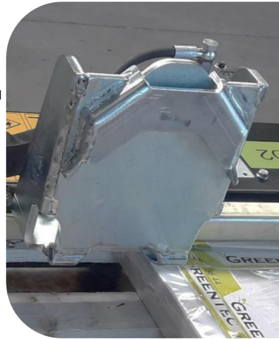
Mechanischer Schnellwechsel montiert auf LRS 1602 Astsäge: ("weiblicher" Teil)
