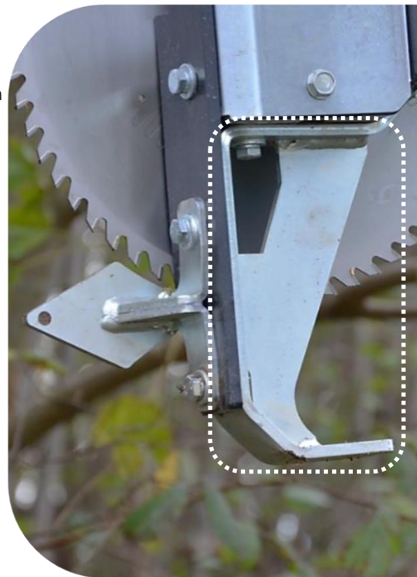
Schleppschuhe bei unteren Sägeblatt montiert
