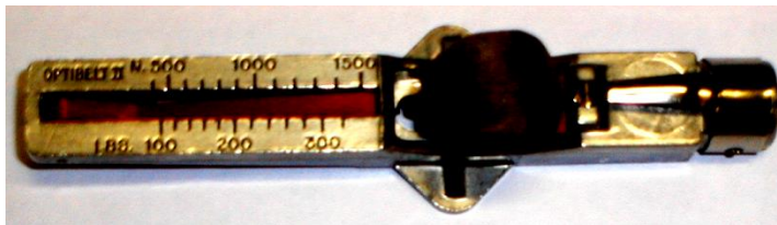
Werkzeug zum Nachmessen der Riemenpannung Optikrik II Part no. 200155.0
