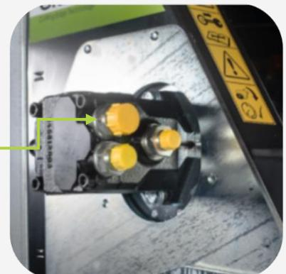
Tabelle 40 – Messung von Druck und Durchfluss: LRS 2002 Astsäge
