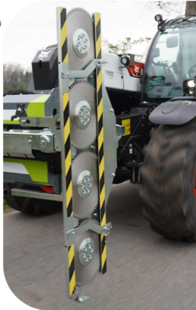
Um die Sägeblätter herum montierter Schutzschienen
