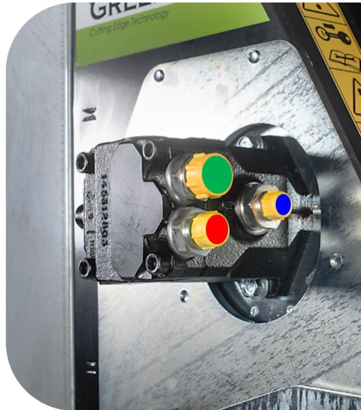
Hydraulischer Kolbenmotor an der LRS 2002 Astsäge
