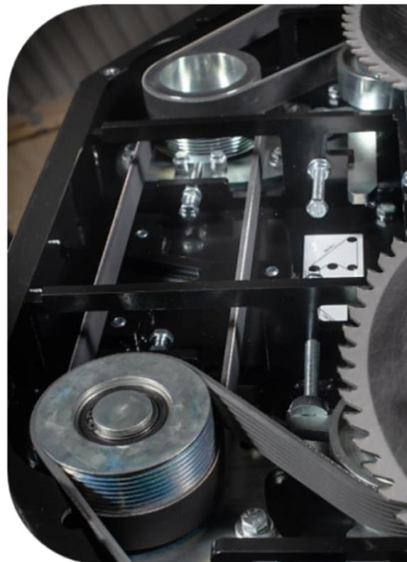
Power-Band Riemenantrieb am LRS 2002 Astsäge
