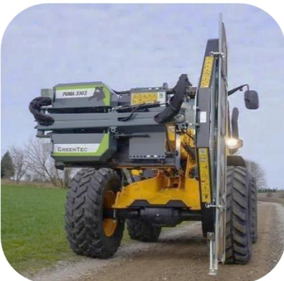
Beispiel für Transportstellung: LRS-Astsäge zusammenmontiert mit PUMA 3303 Multiträger. (Freie Beleuchtung an Fahrzeug)
