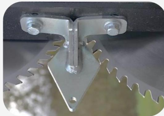
\* Die Astführungen müssen so nah wie möglich an den Sägeblättern ausgerichtet werden, ohne an die Sägeblätter anzustoßen.
