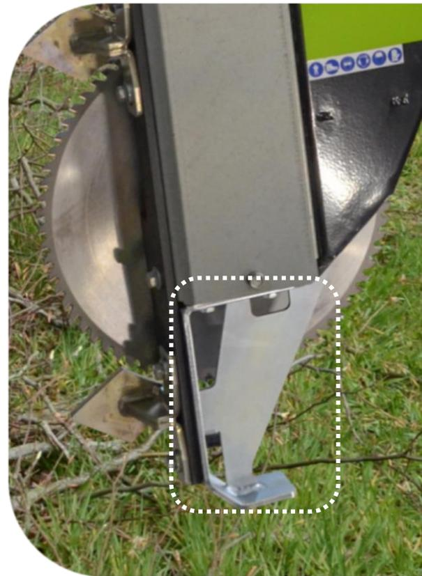
Schleppschuhe bei unteren Sägeblatt montiert
