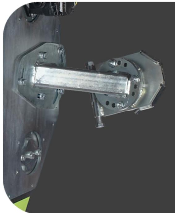
Mechanischer Schnellwechsel montiert auf LRS 2002 Astsäge: ("weiblicher" Teil)
