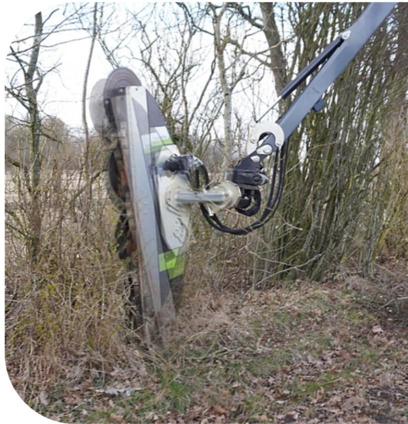
Schnittwinkelseinstellung an der LRS 2002 Astsäge
