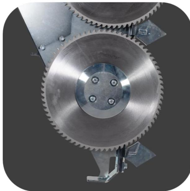
Sägeblätter sind mit Korrosionsschutz-Öl beschichtet
