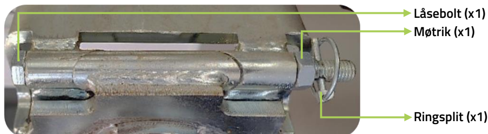
Eksempel: Mekanisk hurtigskifte "han" adapter på Scorpion armklipper.
