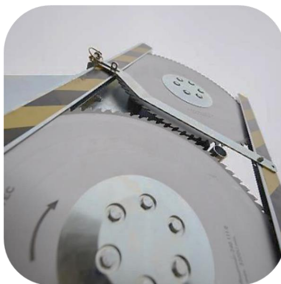
LRS 2002 Grensav i transportstilling med påmonterede sikkerhedsanordninger (Beskyttelsesskærme for savklinger)
