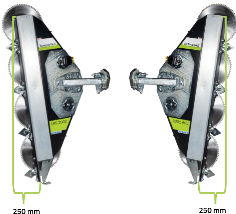
Forskydning / vinkling af grensav i lodret retning
