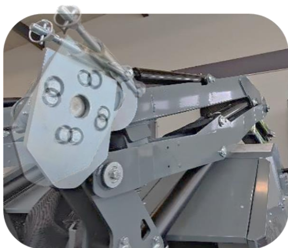
Eksempel: Mekanisk hurtigskifte "han" adapter på Scorpion armklipper.
