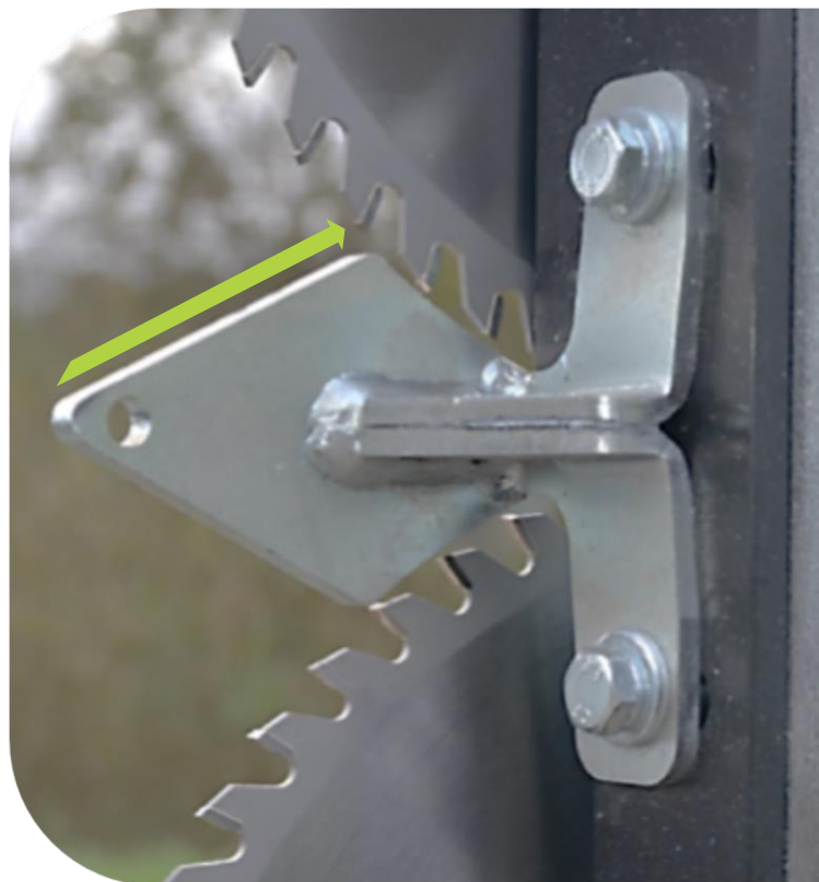
Justering af grenfører på LRS 2002 grensav
