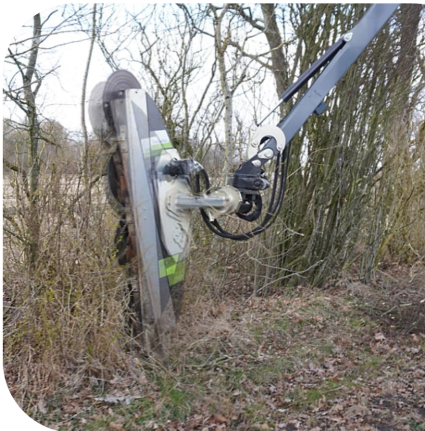
Indstilling af klippevinkel på LRS 2002 Grensav
