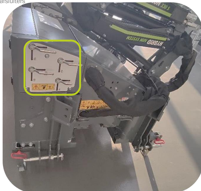
Plaats van transportvergrendelingen / stopkranen op de Scorpion 3-430
