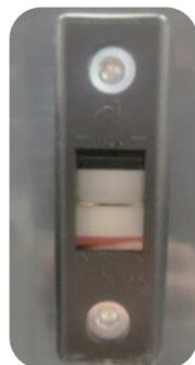
Kijkglas voor het bekijken van het hydraulieoliepeil in de tank
