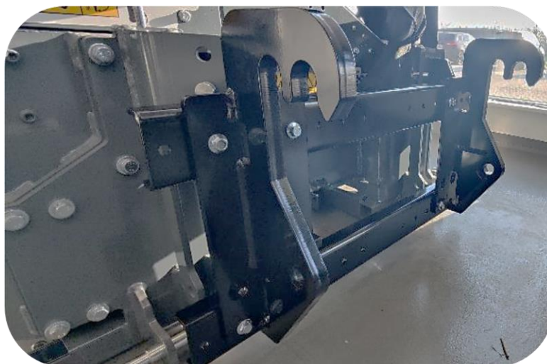
Montageframe en ladersteun zijn bij levering gemonteerd op de Scorpion 3-430 armmaaier.
