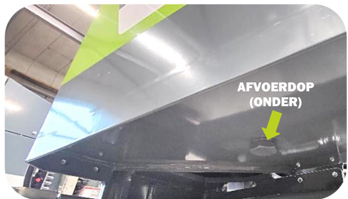
Afvoerdop voor olietank op Scorpion 3-430 armmaaier
