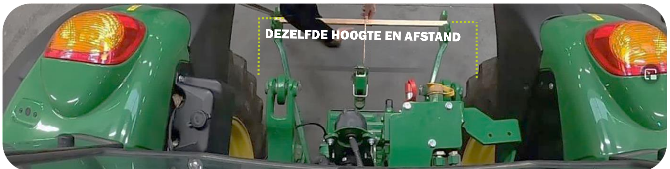
De hefarmen van het voertuig op dezelfde hoogte en afstand instellen
