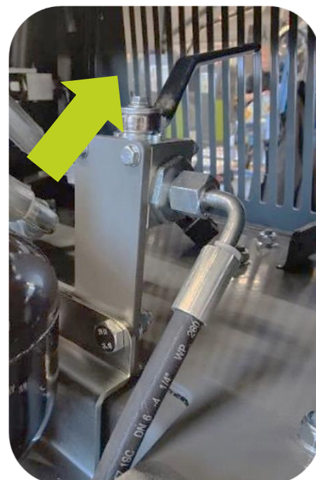
Afsluitklep (1x) voor het schakelen van werktuigen
