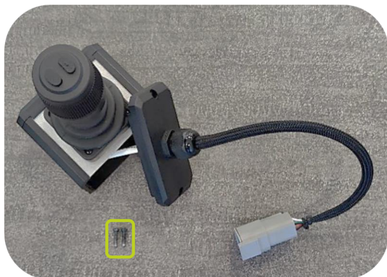
Eindplaat met kabel losgekoppeld van joystick
