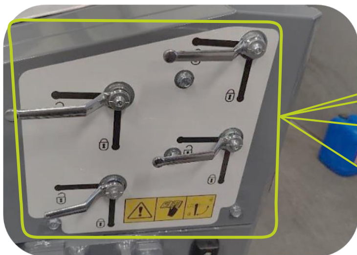
Stopkranen (4x) voor het blokkeren van cilinders tijdens transport en opslag
