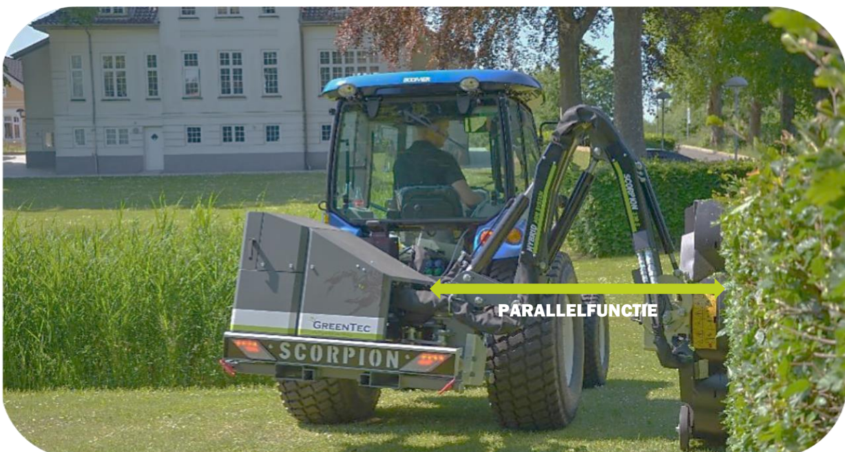
Scorpion 3-430 armmaaier in gebruik met parallelfunctie geactiveerd
