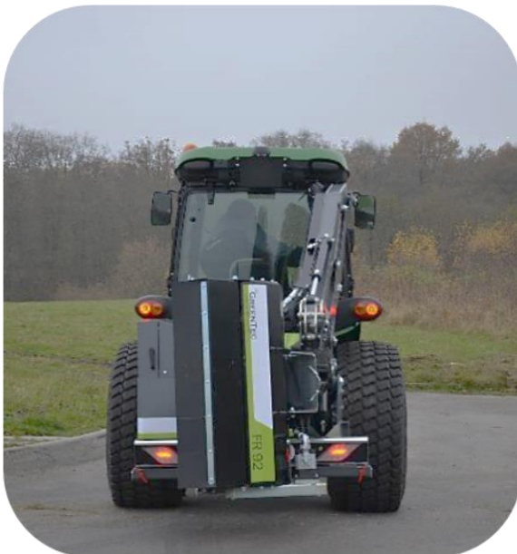
Voorbeeld van transportstand: Scorpion 3-430 armmaaier en FR 92 Klepelmaaier (achterop gemonteerd): Alle lichten vrij op de maaier en het voertuig
