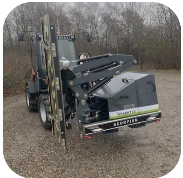
Voorbeeld van transportstand: Scorpion 3-430 armmaaier en LRS 1402 Zaagunit (voorop gemonteerd): Veiligheidsafscherming gemonteerd op zaagbladen
