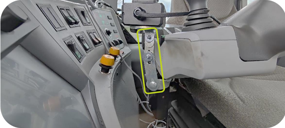
Joystick met schuine montagebeugels, vastgeschroefd op de console/armsteun van het voertuig
