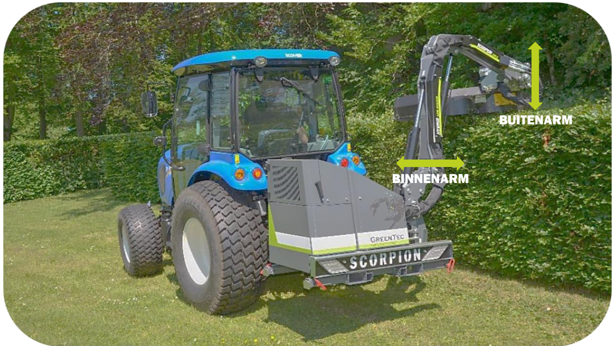
Scorpion 3-430 armmaaier in gebruik met niet-parallelfunctie geactiveerd
