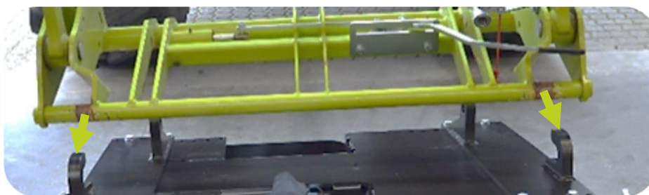
Voorbeeld van montage van het hefsysteem met aanbouwraam / speciale adapter
