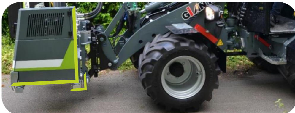
Scorpion 3-430 Basic opgetild en gemonteerd met nekbevestiging op voertuiglif in verticale positie
