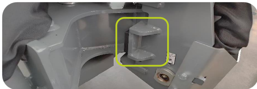
Sluitblok om de rotatie van het Scorpion 3-430 armmaaier armsysteem te beperken
