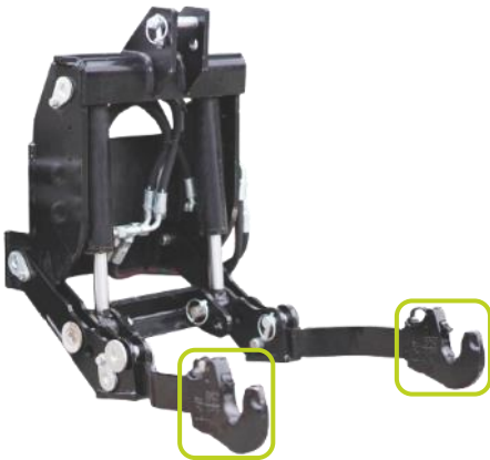
Standaard hydraulisch hefarm systeem op voertuigen
