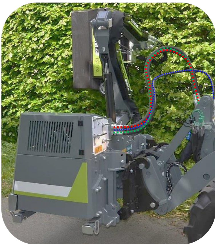
Hydraulische verbindingen tussen Scorpion 3-430 Basic model en voertuig
