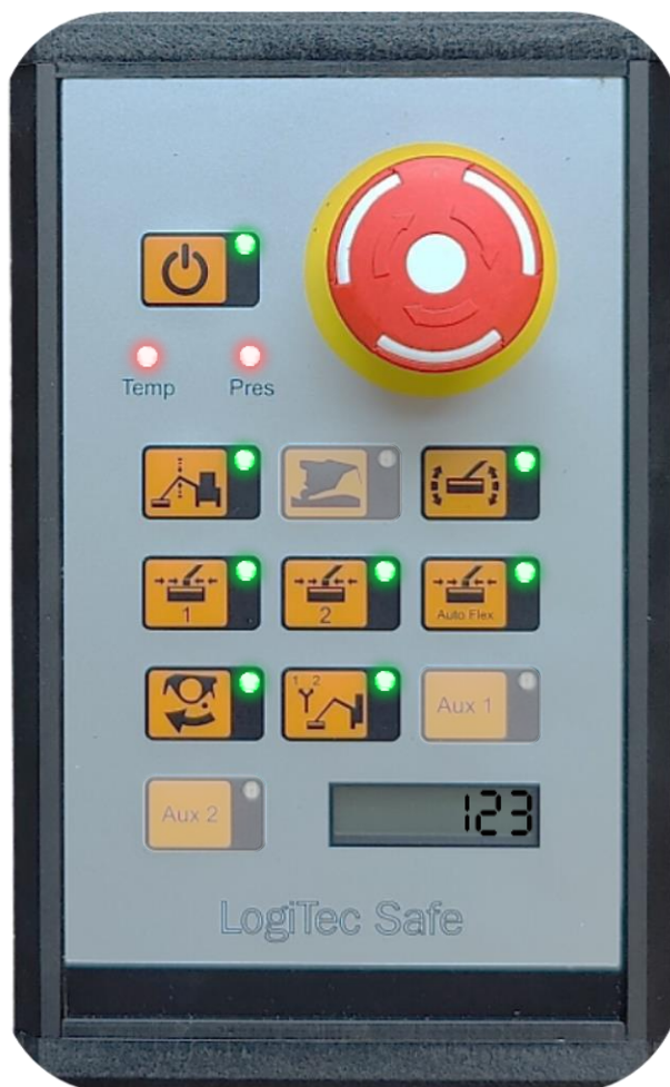
LogiTec Safe bedieningspaneel op de Scorpion 3-430 armmaaier: (Alle standaard- en Plus modellen)
