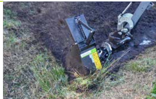
Cureuse de fossé GR 70
