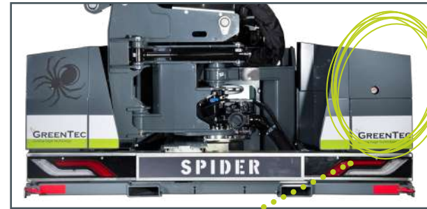
Der 220-Liter-Hydrauliktank befindet sich auf der rechten Seite, während die Hydraulikventile und der Ölkühler auf der linken Seite sitzen.
