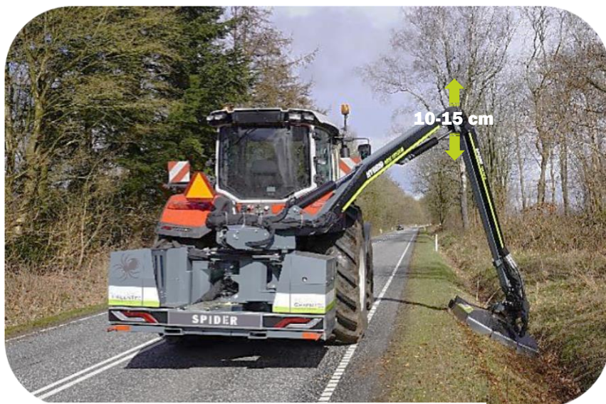
Kørsel med flydestillingsfunktion for arm på Spider 5-820 Plus armklipper
