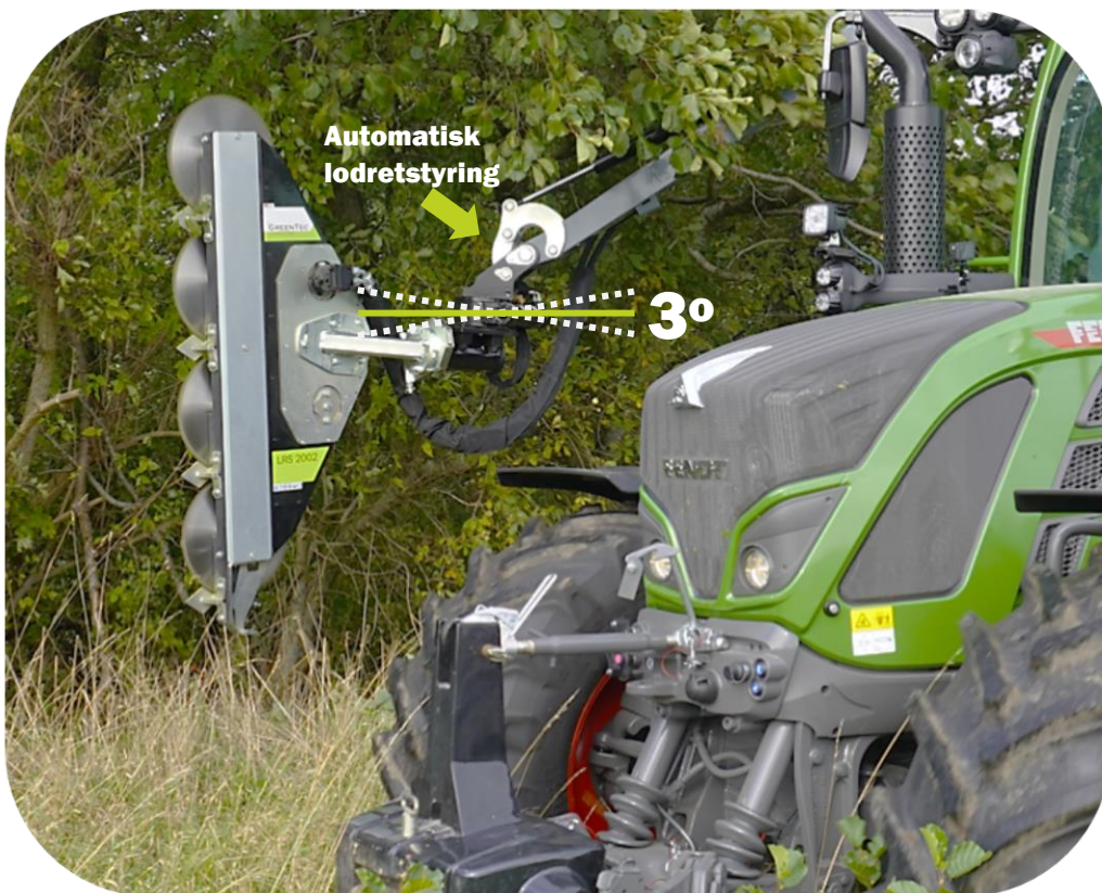
Kørsel med AutoFlex-funktionen (Automatisk lodretstyring) aktiveret: Spider 5-820 Plus armklipper
