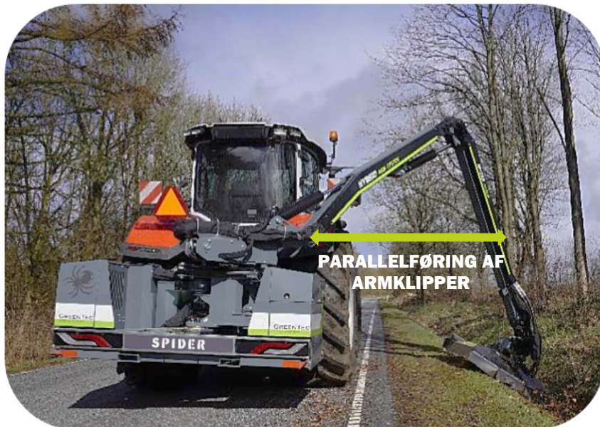
Spider 5-820 Plus armklipper under anvendelse med parallelføring af armklipper
