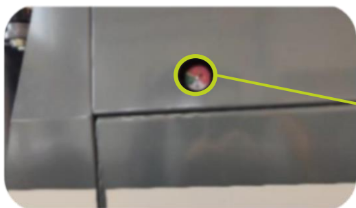
Manometer/indikator for skift af returfilter
