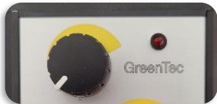
AHC-potentiometer på betjeningspanel i "0"-position
