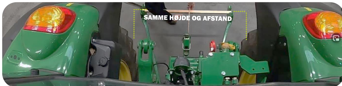
Justering af køretøjets liftarme i samme højde og afstand
