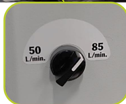
Kontakt for skift af olieforsyning til arbejdsredskab: 50 ell. 85 l/min.
