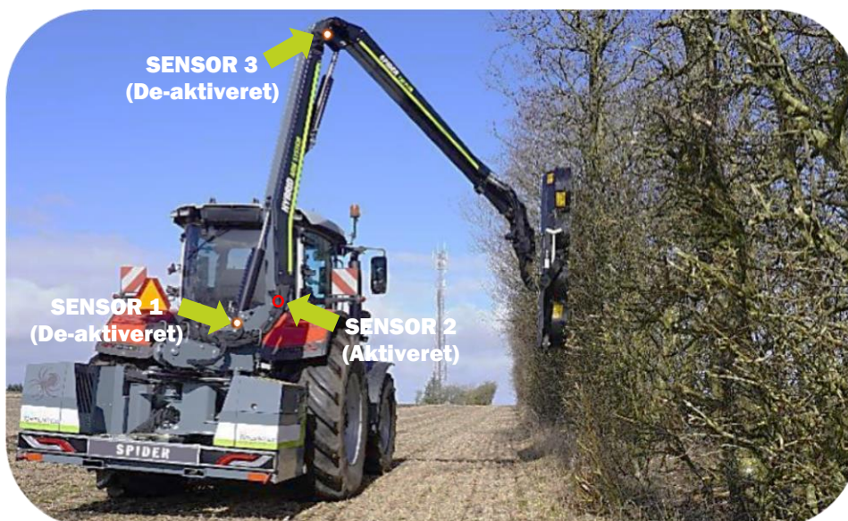
Sikkerhedssensor 2 blokeret og herved aktiveret: Spider 5-820 Plus armklipper
