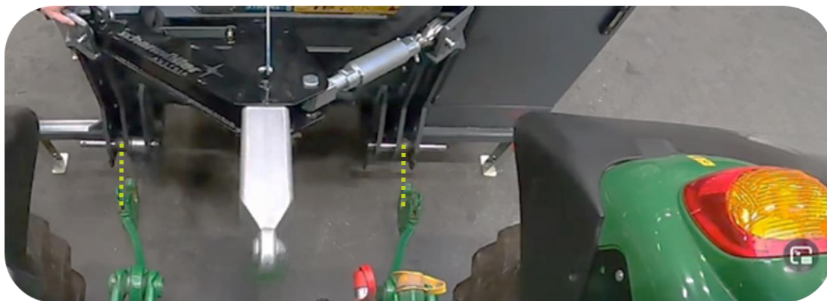
Køretøjet bakkes forsigtigt op til monteringspunkterne på Spider 5-820 Plus armklipperen
