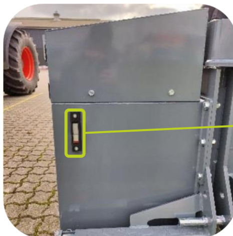
Placering af måler for olieniveau på Spider 5-820 Plus-armklipper
