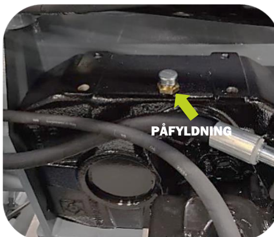
Påfyldning af gearolie på Spider 5-820 Plus-armklipper
