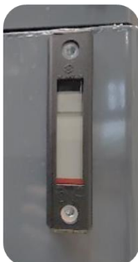
Skueglas for kontrol af hydraulikolieniveau i tank
