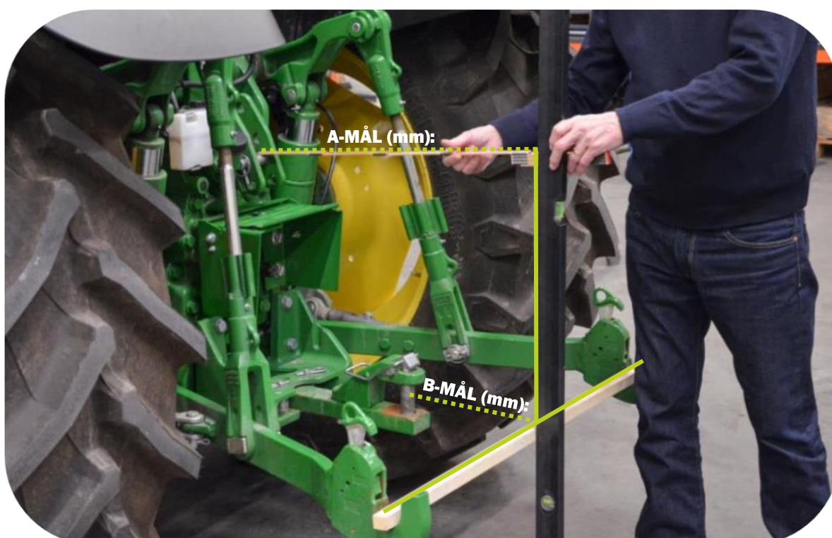
Udmåling af 4-punkts montering på køretøj: "A"-mål (øvre) og "B"-mål (nedre)
