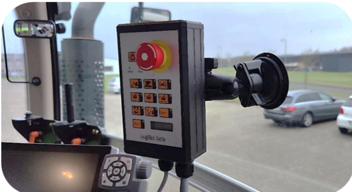
Betjeningspanel monteret op i kabine på køretøj vha. Ram-mount
