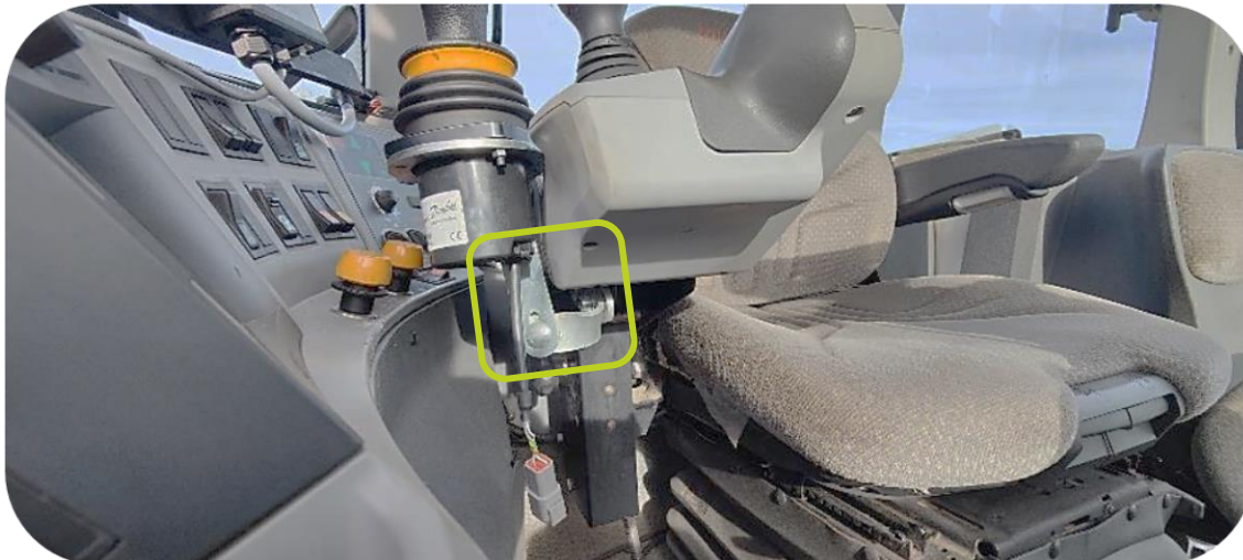
Joystick med vinklede monteringsbeslag, boltet op på køretøjets konsol/armlæn
