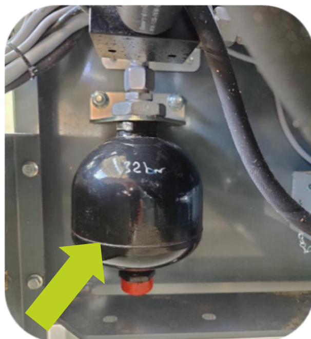
Akkumulator (32 bar) på Spider 5-820 Plus armklipper
