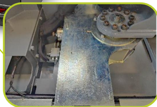
Drejeenhed for klipperarm på Spider Plus-armklipper: 270° svingdrev
