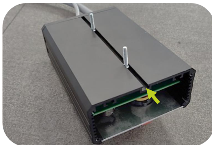
Udskæring til stålsætskruer på bagside af betjeningspanel
