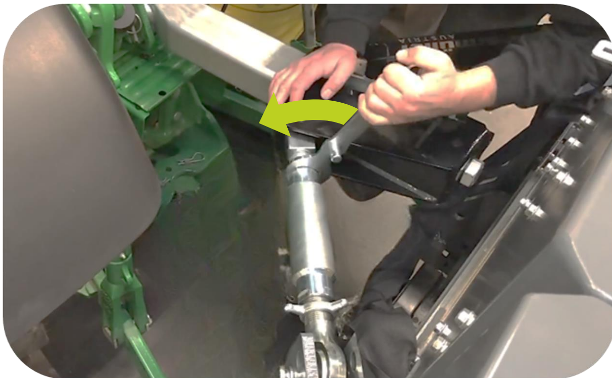
Justering af tværgående topstang for tilspænding af stabiliseringen mellem køretøj og armklipper
