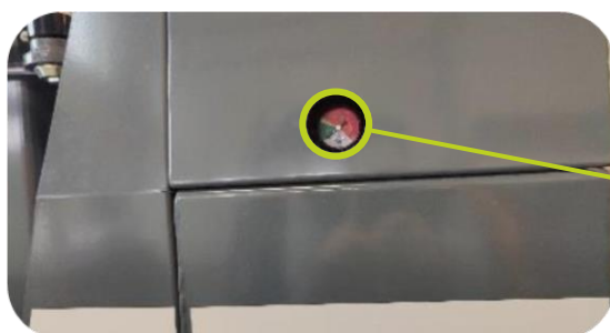
Manometer/indikator for skift af returfilter
