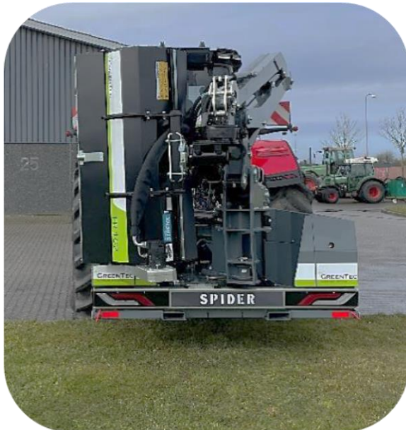
Eksempel på transportstilling: Spider 5-820 Plus armklipper og FR Slagleklipper (bagmonteret): Lygter fri på armklipper og køretøj
