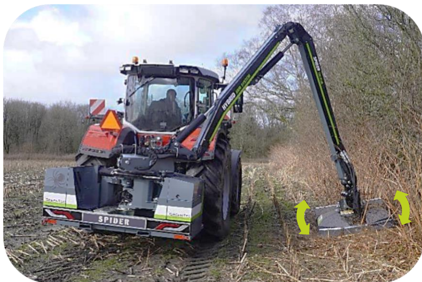
Kørsel med flydestillingsfunktion for arbejdsredskab på Spider 5-820 Plus
