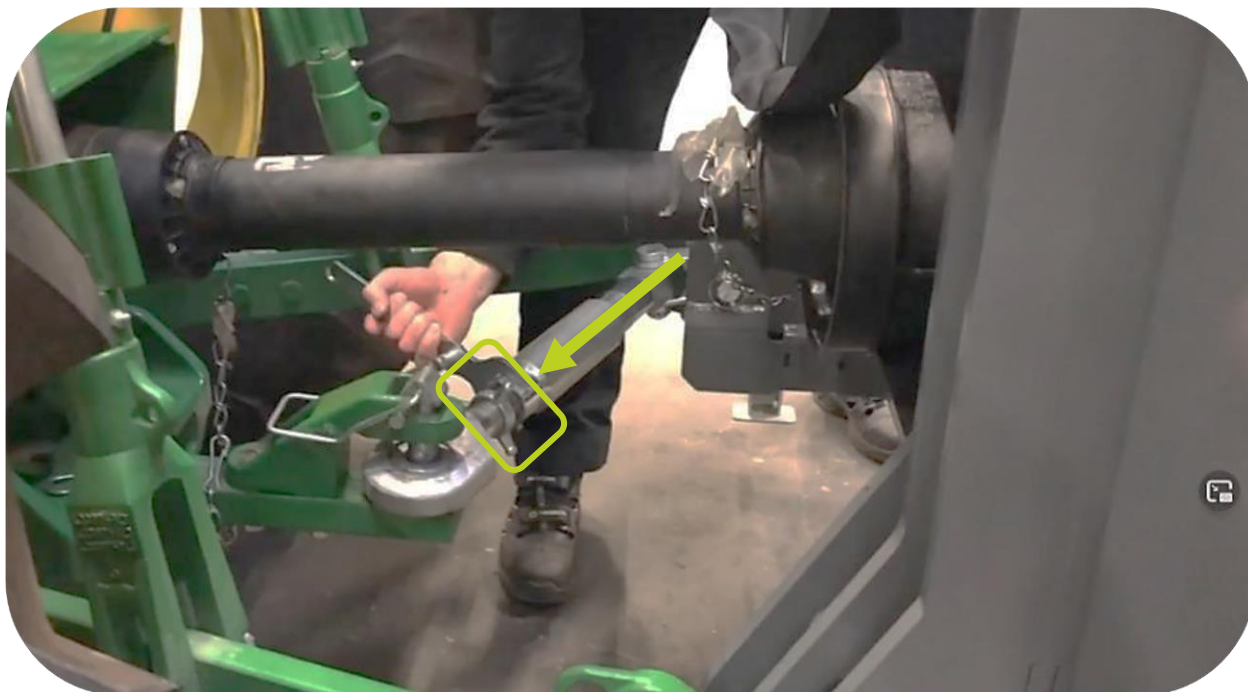
Nederste stabilisator stang monteres mellem armklipper og køretøjets nederste trækpunkt
