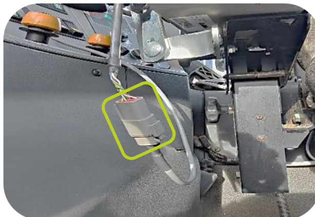
Tilslutning af joystick vha. 1 stik/kabel fra betjeningspanel
