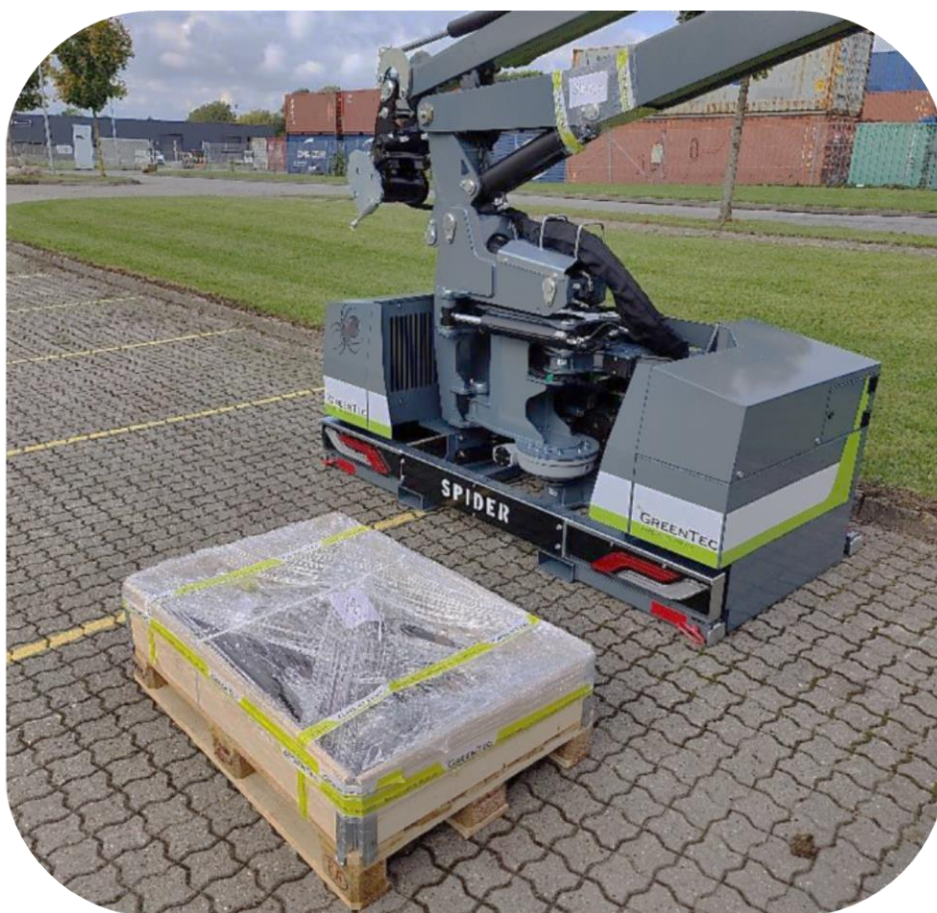
Spider 5-820 Plus armklipper som den leveres fra fabrikken inkl. transportpalle m. diverse løsele
