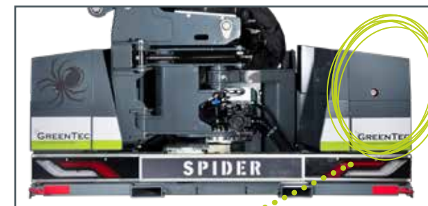
Le réservoir hydraulique de 220 litres est situé sur le côté droit, et les vannes hydrauliques et le refroidisseur d'huile sont situés sur le côté gauche.
