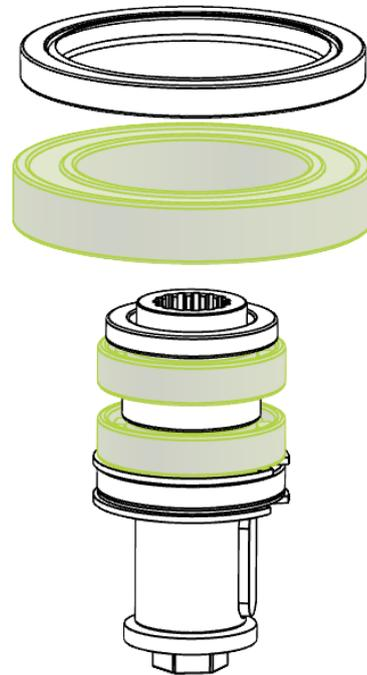
Kugellager auf der Welle des Messerrotors
