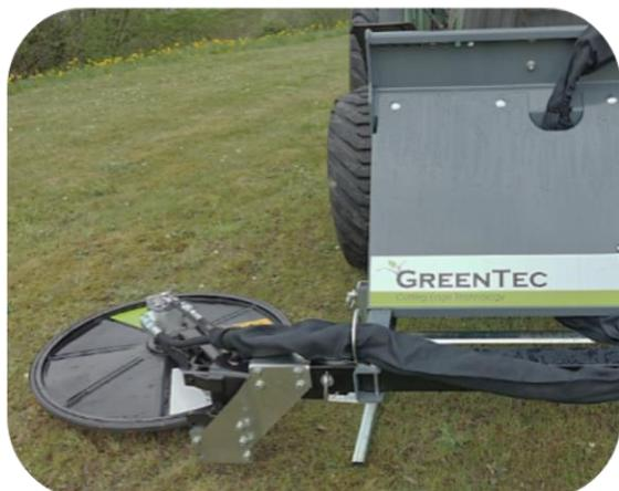
FOX-Multiträger montiert mit RI-Zaunmäher in Arbeitsposition. Mit dem Armsystem des Multiträgers kann die Reichweite des Anbaugerät weiter vergrößert werden.
