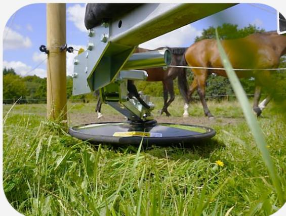
Wenn der RI-Zaunmäher beim Mähen unten mit der Stützplatte am Boden entlang gefahren wird, ergibt sich eine Mähhöhe von ca. 30-35 mm.
