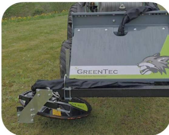
FOX-Multiträger montiert mit RI-Zaunmäher in Transportstellung. Für maximale Verkehrssicherheit ist das Anbaugerät nach innen zum Fahrzeug gedreht.
