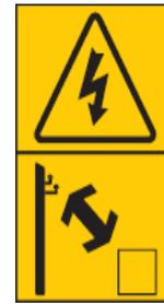
Je höher die Spannung, desto größer ist der erforderliche Abstand zwischen den Stromleitungen und der Maschine! Im Zweifelsfall wenden Sie sich für Sicherheitshinweise immer an das örtliche Energieversorgungsunternehmen!
