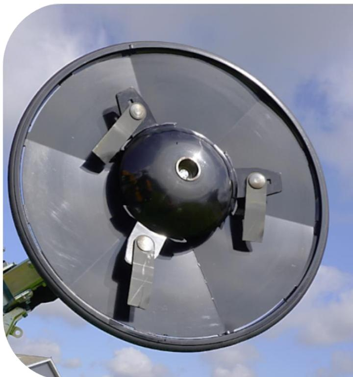
Messerrotor mit gehärteten Stahlblättern
