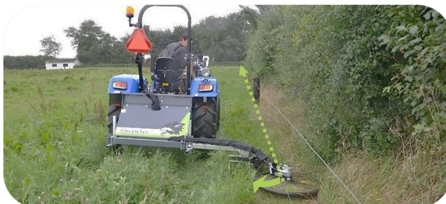
6. Die Fahrgeschwindigkeit beim Einsatz des RI-Zaunmähers darf max. die Geschwindigkeit beträgt ca. 3-4 km/h und muss immer so eingestellt werden, dass das Schnittergebnis optimal ist.
