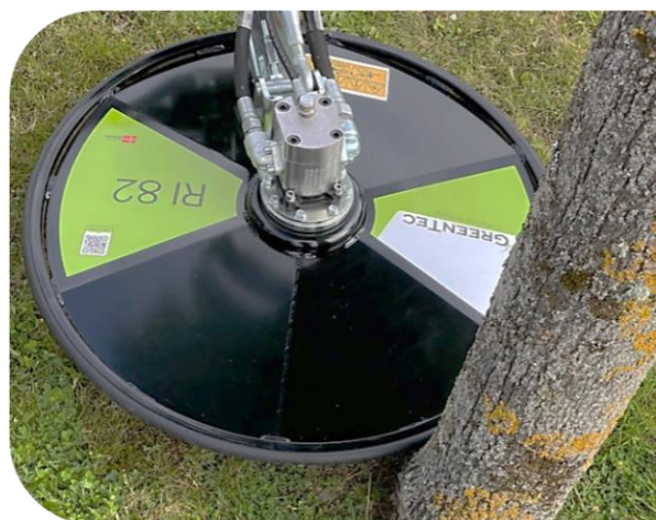
Gummibeskyttelse omkring klippehoved
