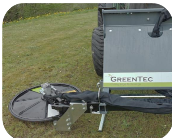
FOX redskabsramme monteret med RI Kantklipper i arbejdsposition. Redskabet kan yderligere ydskydes i rækkevidde vha. redskabsrammens armsystem.
