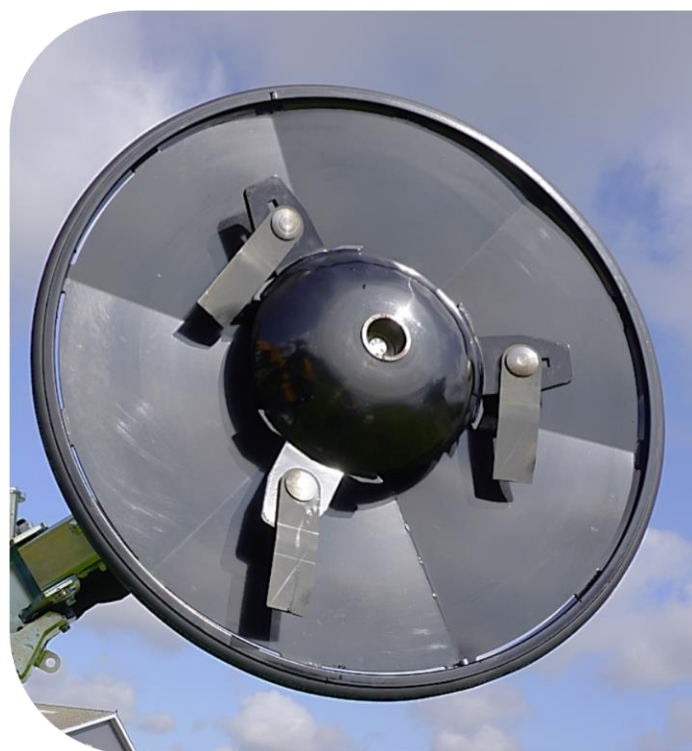
Knivrotor med knive i hærdet stål
