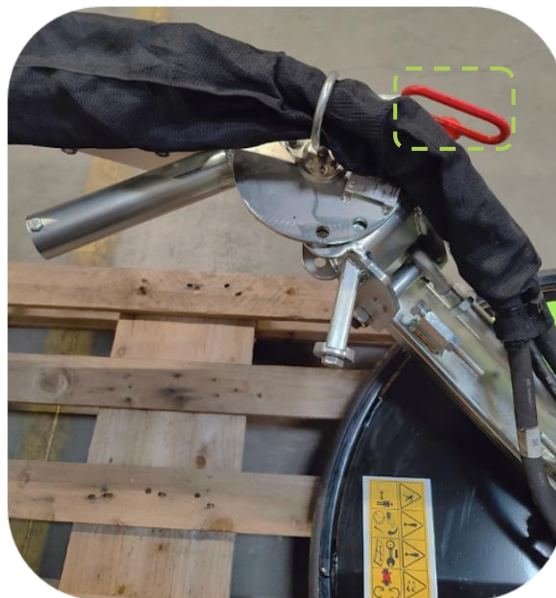
RI Kantklipper i udslået og ulåst position (Arbejdsposition)
