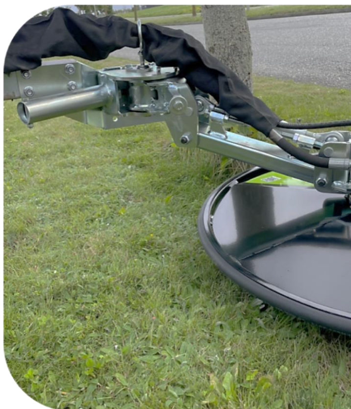
Fjederpåvirket armsystem / "break-back"-funktion
