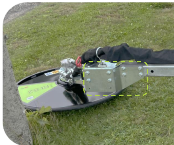
Eksempel på basisbeslag for RI 62-82 ↔ FOX redskabsramme
