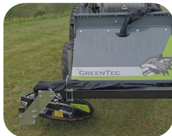
FOX redskabsramme monteret med RI Kantklipper i transportposition. Redskabet er vendt indad mod køretøjet, for maksimal trafiksikkerhed.
