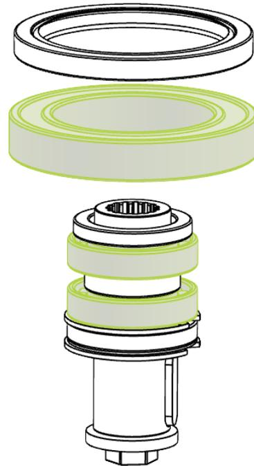
Roulements à billes sur l'arbre du rotor à pales
