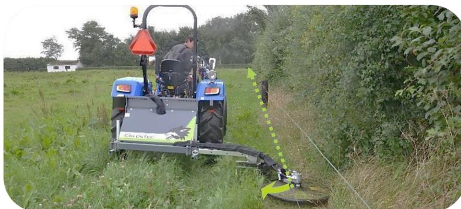
6. La vitesse de travail lors de l'utilisation du broyeur sous clôture RI doit être de maxi. 3-4 km/h (1,86-2,49 mi/h) et doit toujours être adaptée de sorte que le résultat de la coupe soit optimal.
