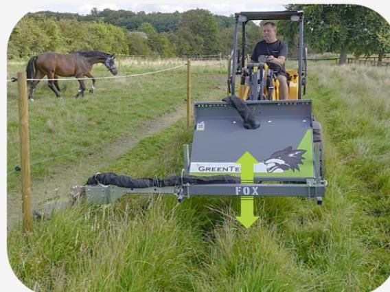
\* Déploiement mécanique du système de bras : FOX, HXF 2302 et 2802, PUMA 2303 et 2803. Système de bras télescopique électro-hydraulique : HXF 2802 Tele, PUMA 2803 Tele.
