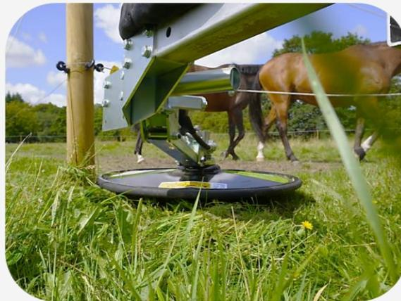
Si la plaque de protection du broyeur sous clôture RI est entièrement abaissée et touche le sol, on obtient une hauteur de coupe d'environ 30-35 mm (1,18-1,38"). Voir le chapitre : [Réglage et ajustement de la machine \(r\)](#) – page 49-53.
