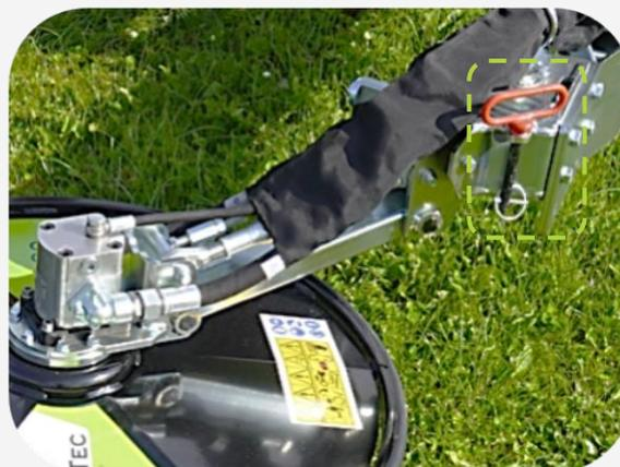
3. Utilisez les fonctions du véhicule et du multiporteur adéquat pour diriger et placer le broyeur sous clôture RI dans la position la plus appropriée pour le travail à effectuer. \*\*
