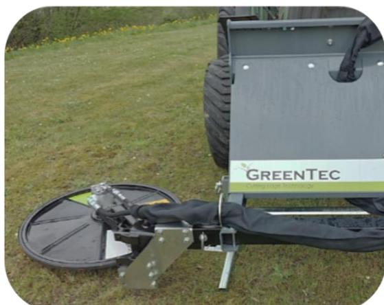
Multiporteur FOX monté avec broyeur sous clôture RI en position de travail. Le système de bras du multiporteur permet d'étendre la portée de l'outil de travail.
