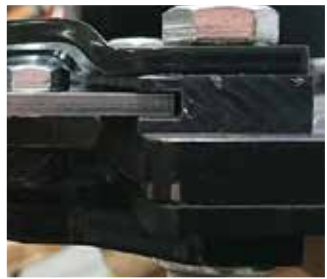
KUNSTSTOFFFÜHRUNG DER MESSERBALKEN
