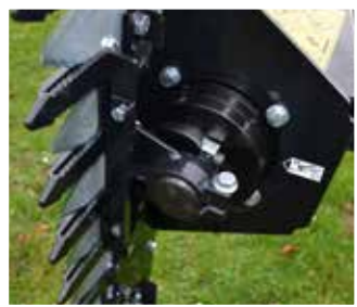
HOCHLEISTUNGS-PLANETEN- ANTRIEB DER MESSER
