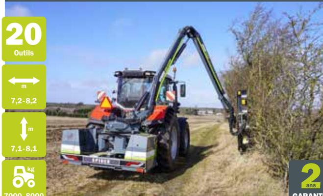
Les deux plus grands modèles, 720 et 820, sont livrés montés à l'arrière.
