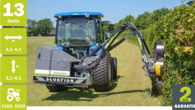
La série 4 est spécialement dédiée aux tracteurs compacts avec un poids vide de 1.500 kg ou plus ou pour le montage sur divers chargeurs ou porte-outils.
