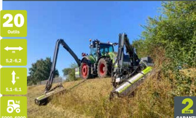
Les deux plus petits modèles, 520 et 620, sont livrés montés à l'avant ou à l'arrière.
