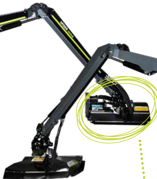
Dreheinheit: Die Dreheinheit kann um 180° von rechts nach links bewegt werden. Sowohl die Seitendreh-Einheit als auch die Schwenkfunktion des Arms sind in beide Richtungen kollisionsgeschützt.
