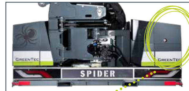
Le réservoir hydraulique de 220 litres est situé sur le côté droit, et les vannes hydrauliques et le refroidisseur d'huile sont situés sur le côté gauche.
