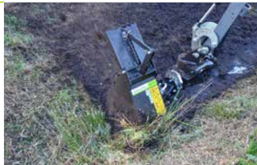
Cureuse de fossé GR 70
