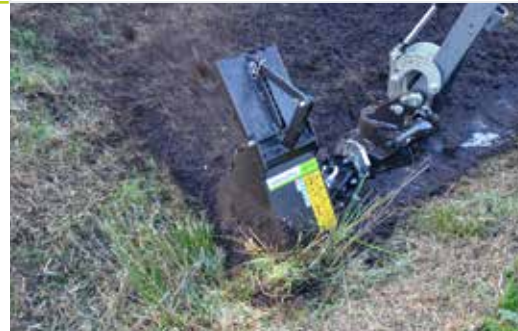
Cureuse de fossé GR 70
