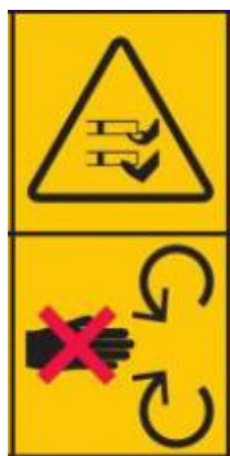
Abb. 4: Schutzeinrichtungen während des Betriebes nicht öffnen oder entfernen.
