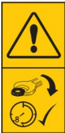
Abb. 3: Überprüfen Sie alle 8 Betriebsstunden, ob alle Schrauben/Muttern festgezogen sind.
