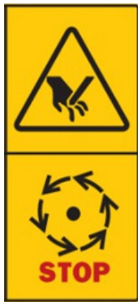
Abb. 5: Maschinenteile erst berühren, wenn diese zum Stillstand gekommen sind.
