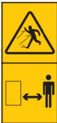
Abb. 6: Gefahr durch herausgeschleuderte Teile bei laufendem Motor - Sicherheitsabstand halten.
