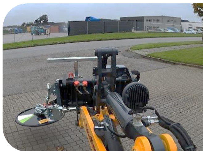
PUMA 2303 redskabsramme monteret på frontlæsser m/ RI-82 Kantklipper
