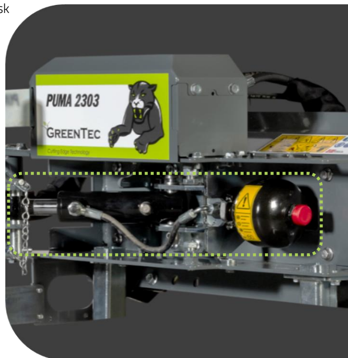
Akkumulator tilkoblet påkørselcylinder
