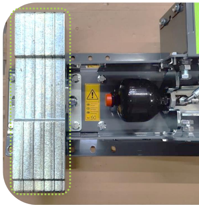
Kontravægte (50 kg.) monteret på PUMA 2303 redskabsramme
