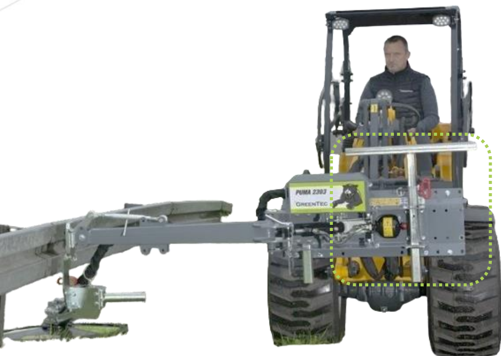
RI Kantklipper monteret på PUMA 2303 redskabsramme. Afstillingsfod/standard her opløftet.
