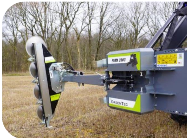
Eksempel på PUMA 2803 redskabsramme monteret på frontlæsser m/ LRS 1602 Grensav
