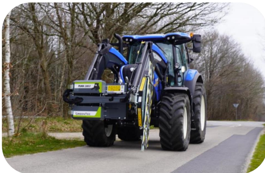
Eksempel på transportstilling: Lygter fri på køretøjet, frit udsyn, med sikkerhedsanordninger monteret på arbejdsredskabet, vendt ind mod køretøjet for maksimal trafikikkerhed.
