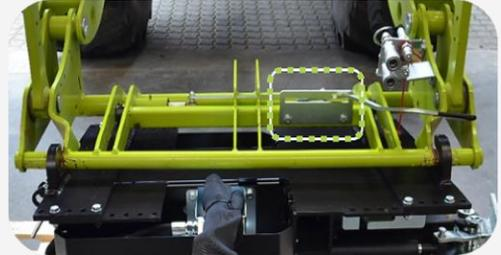
4. Beginnen Sie vorsichtig damit, den PUMA 3303-Multiträger in seine Arbeitsposition zu heben. Die bei Lieferung der Maschine montierten Transporthalterungen werden entfernt und durch die richtigen Stützbeine (3 Stück) ersetzt.
