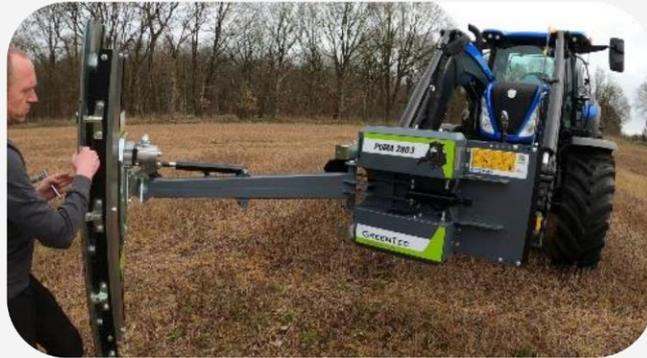
2. Sicherungsbolzen wird wieder zwischen Schwenkarm und Anfahrzylinder montiert, und zwar in einem der 2 Löcher: 0° oder 20° Arbeitswinkel.
