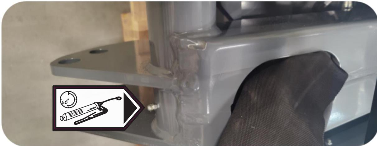
Position des Schmiernippels an der Innerseite des PUMA 3303-Multiträger-Schwenkarms
