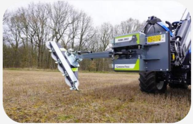
6. Die Fahrtrichtung mit Anbaugeräten muss vorwärts erfolgen und der Kontur des Geländes und/oder der Linie des „Zauns“ folgen. Der Anfahrtschutz (AHS) wird nur in Vorwärtsrichtung aktiviert und wirkt gleichzeitig als mechanischer Vordruck auf die Schneiden des Anbaugeräts gegen das zu bearbeitende Material.
