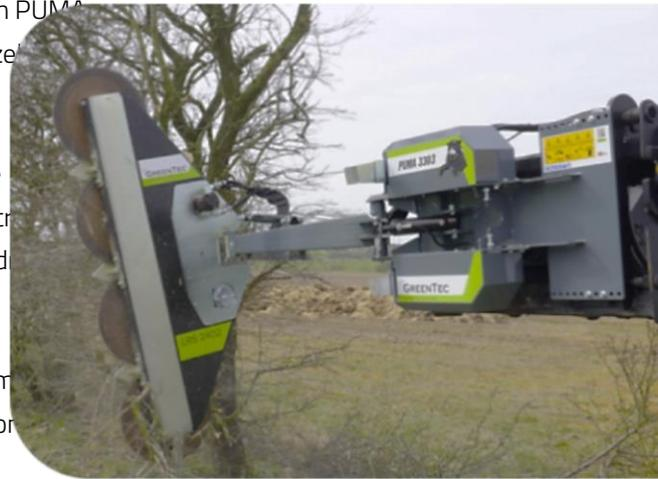
Beispiel eines an einem Frontlader montierten PUMA 3303-Multiträger mit der LRS 2402 Astsäge.
