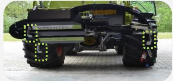
5. Der Hydraulikschlauchsatz wird am Ölmengenteiler der Maschine montiert und dient zur Verbindung zwischen Multiträger und Fahrzeug:
