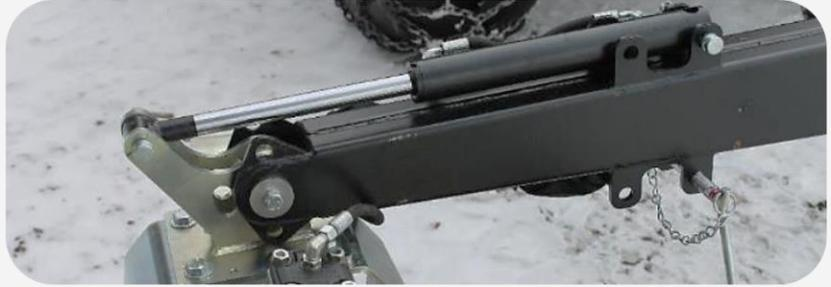
Zur elektrohydraulischen Verstellung (Plus-Modelle) ist ein elektrisch gesteuerter Ventilblock inkl. Zylinder zum Einstellen des Schnittwinkels des Anbaugeräts. Die Justierung des Zylinders erfolgt über die mitgelieferte Fernbedienung.
