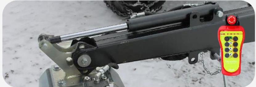
*\* Für die hydraulische Schnittwinkelverstellung an PUMA 3303 Standard ist ein zusätzlicher Ölauslass vom Fahrzeug erforderlich. Von hier aus erfolgt die Neigungsverstellung des Anbaugeräts über die fahrzeugeigene Hydrauliksteuerung. Beachten Sie immer die Betriebsanleitung des verwendeten Fahrzeugs!*
