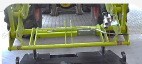
2. Stellen Sie den Frontlader langsam ein und fahren Sie ihn vorsichtig in die Lader-Aufnahme am PUMA 3303-Multiträger. Das Fahrzeug wird vorsichtig gelenkt, sodass der Frontlader in die Haken der Lader-Aufnahme gefahren wird.
