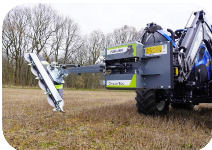
PUMA 3303 redskabsramme med LRS 2002 i delvist vandret position
