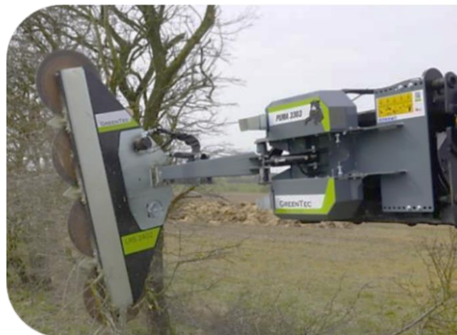
Eksempel på PUMA 3303 redskabsramme monteret på frontlæsser m/ LRS 2402 Grensav
