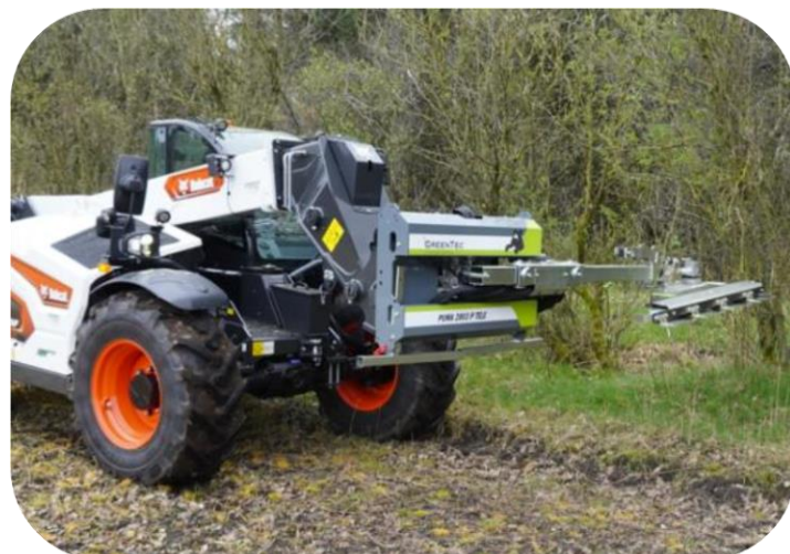
PUMA 2803 Tele redskabsramme med LRS1602 i vandret position
