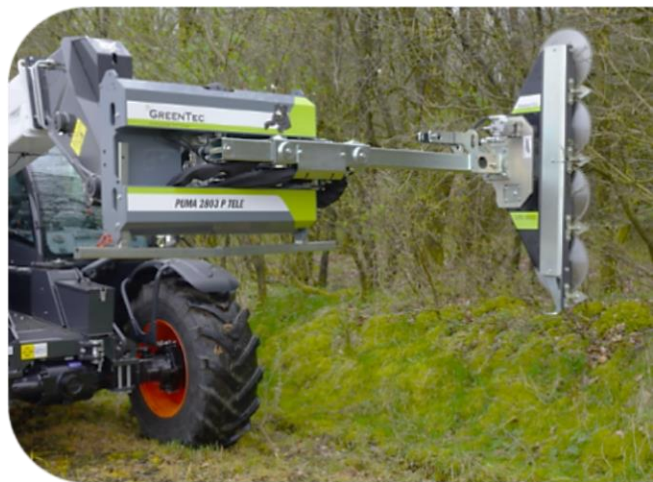
Eksempel på PUMA 2803 Tele redskabsramme monteret på teleskoplæsser m/ LRS 1602 Grensav
