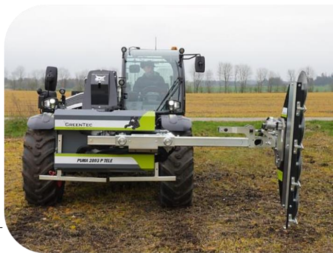
PUMA 2803 Tele redskabsramme i anvendelse m. HL 152 Hækkklipper
