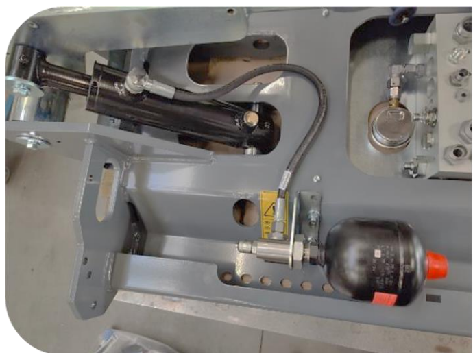
Akkumulator tilsluttet påkørsels cylinder
