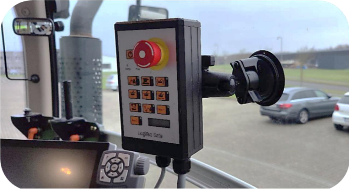
Panneau de commande installé dans la cabine d'un véhicule à l'aide d'un bras de montage RAM
