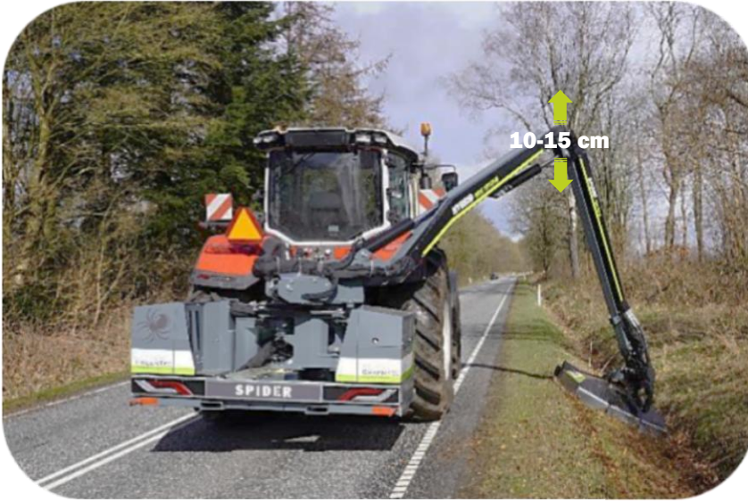
Conduite avec le système hydraulique de position flottante (bras) sur
