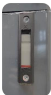
Indicateur du niveau d'huile hydraulique dans le réservoir
