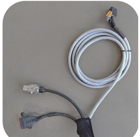
Connexions (3 pièces) des épareuses Spider 5-820 Plus au véhicule
