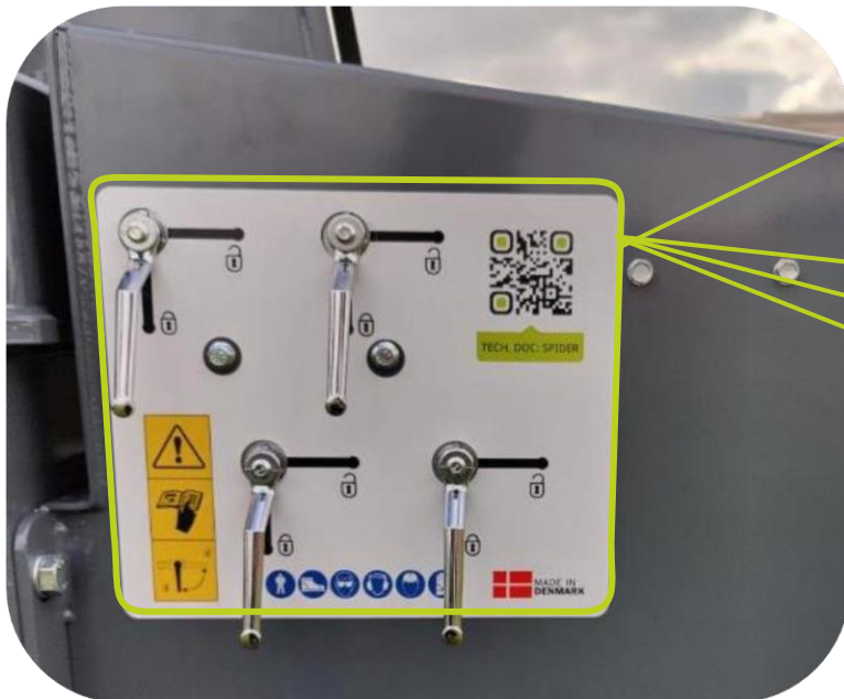
Vannes d'arrêt (4x) pour bloquer les vérins pendant le transport et le stockage
