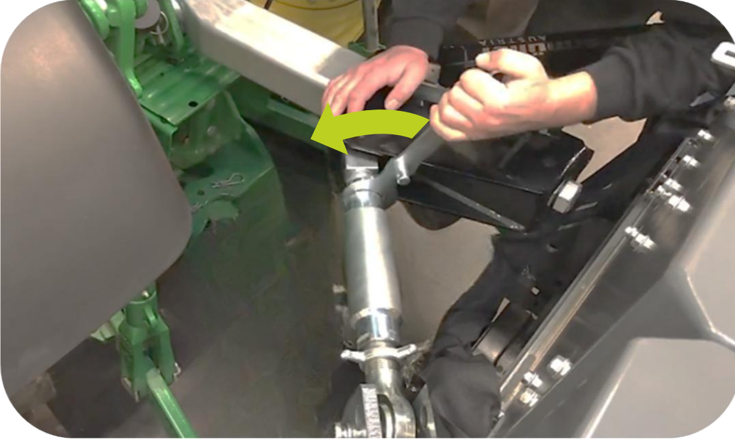
Réglage de la barre d'attelage supérieur transversale servant à serrer le stabilisateur entre le véhicule et l'épareuse
