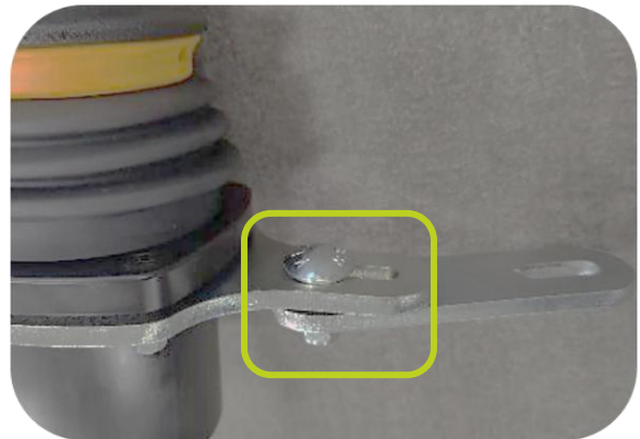
Fixation du support de montage (partie 2)
