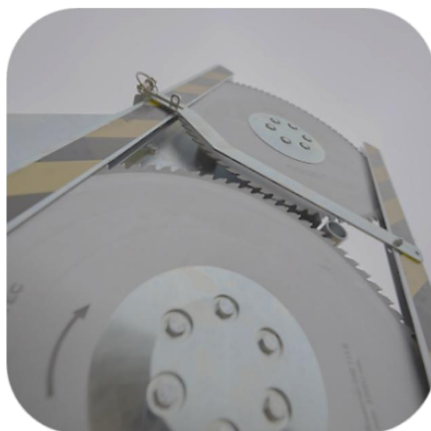
Épareuse Spider 5-820 Plus et lamier LRS 1402 (montée à l'arrière) : dispositif de protection recouvrant les lames de la scie
