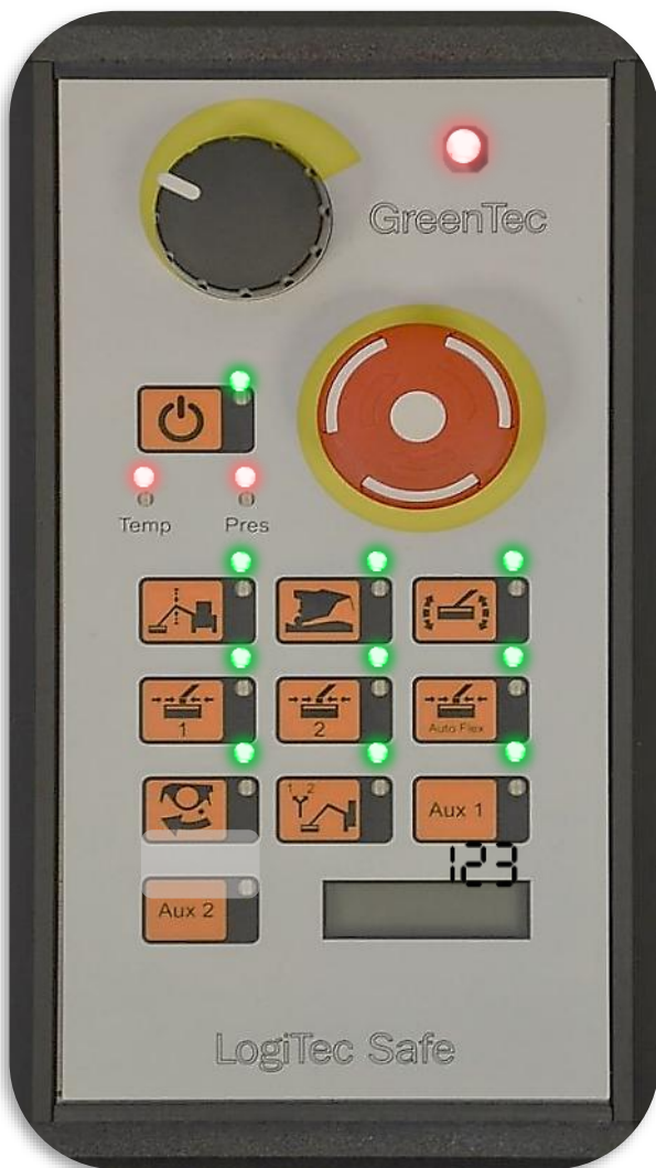
Panneau de commande LogiTec Safe de l'épareuse Spider 5-820 Plus :
