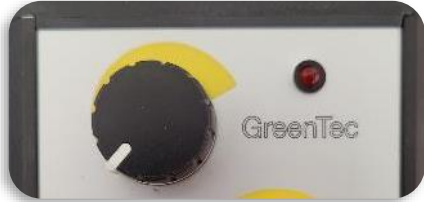
Potentiomètre AHC sur le panneau de commande en position « 0 »
