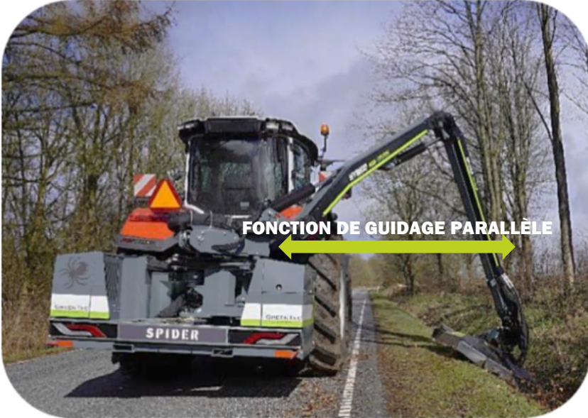
Épareuse Spider 5-820 Plus en cours d'utilisation avec la fonction de guidage
