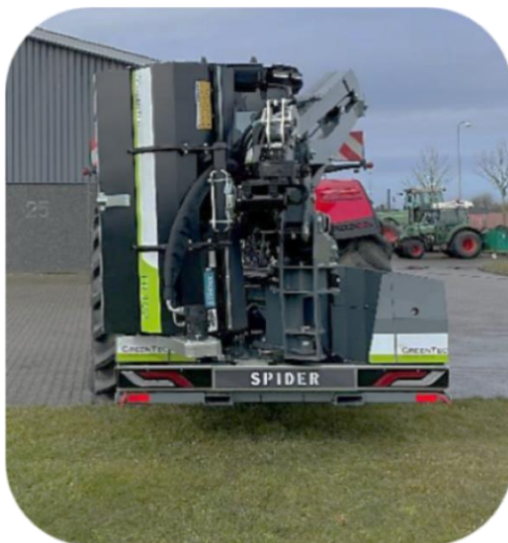
Exemple de position de transport : épareuse Spider 5-820 Plus et débroussailluse FR 92 (montée à l'arrière) : tous les feux d'éclairage sont dégagés sur l'épareuse et le véhicule
