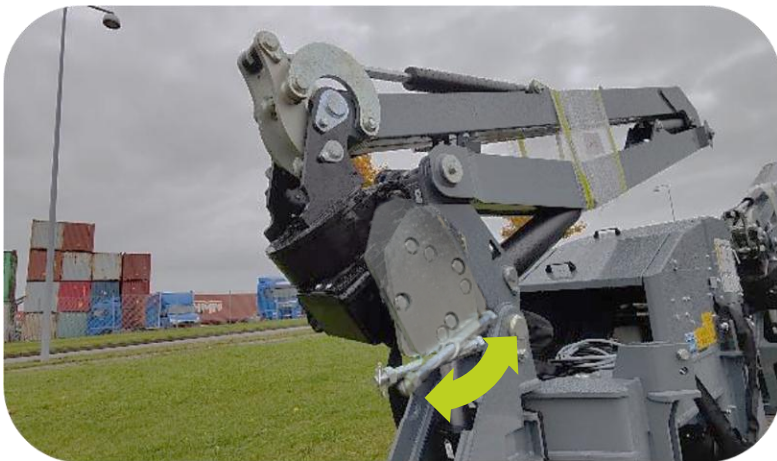
Raccord mécanique à attelage rapide des outils de fixation de l'épareuse Spider 5-820 Plus
