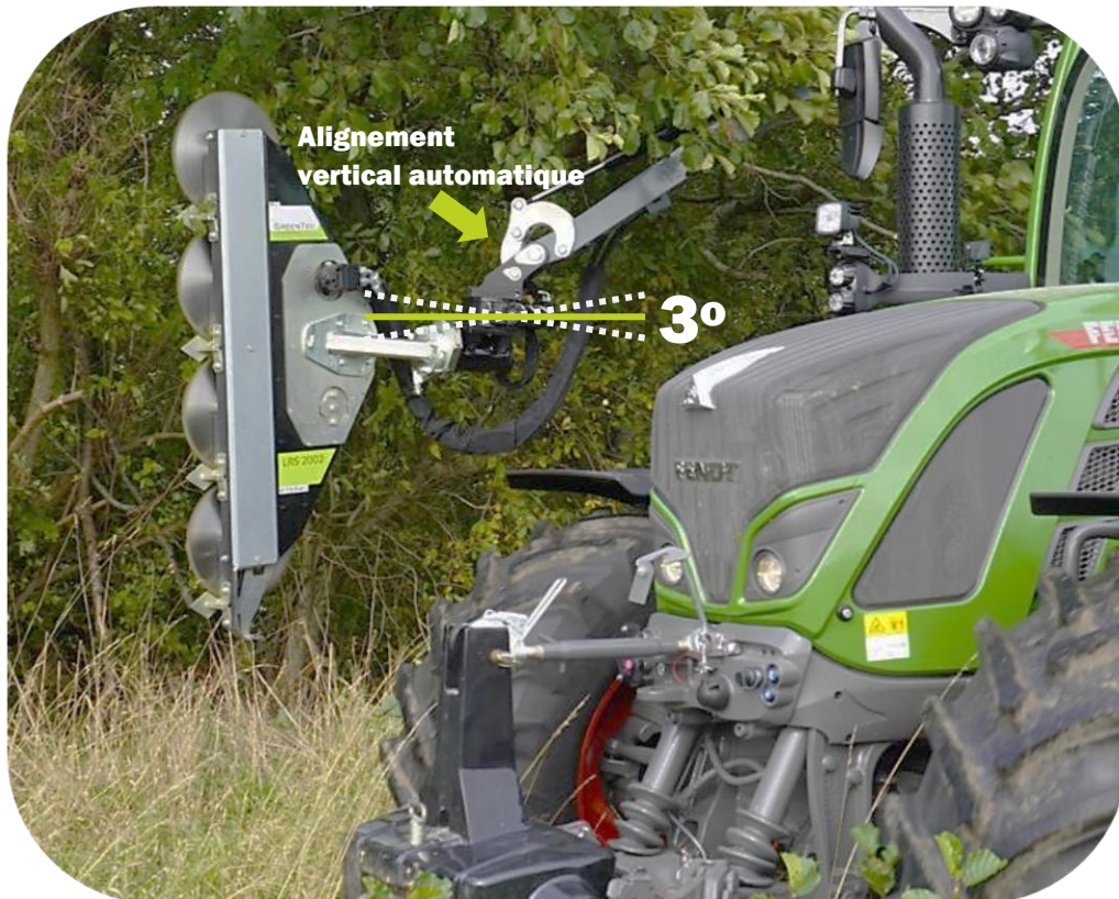
Conduite avec la fonction AutoFlex (alignement vertical automatique) activée : épareuse Spider 5-820 Plus
