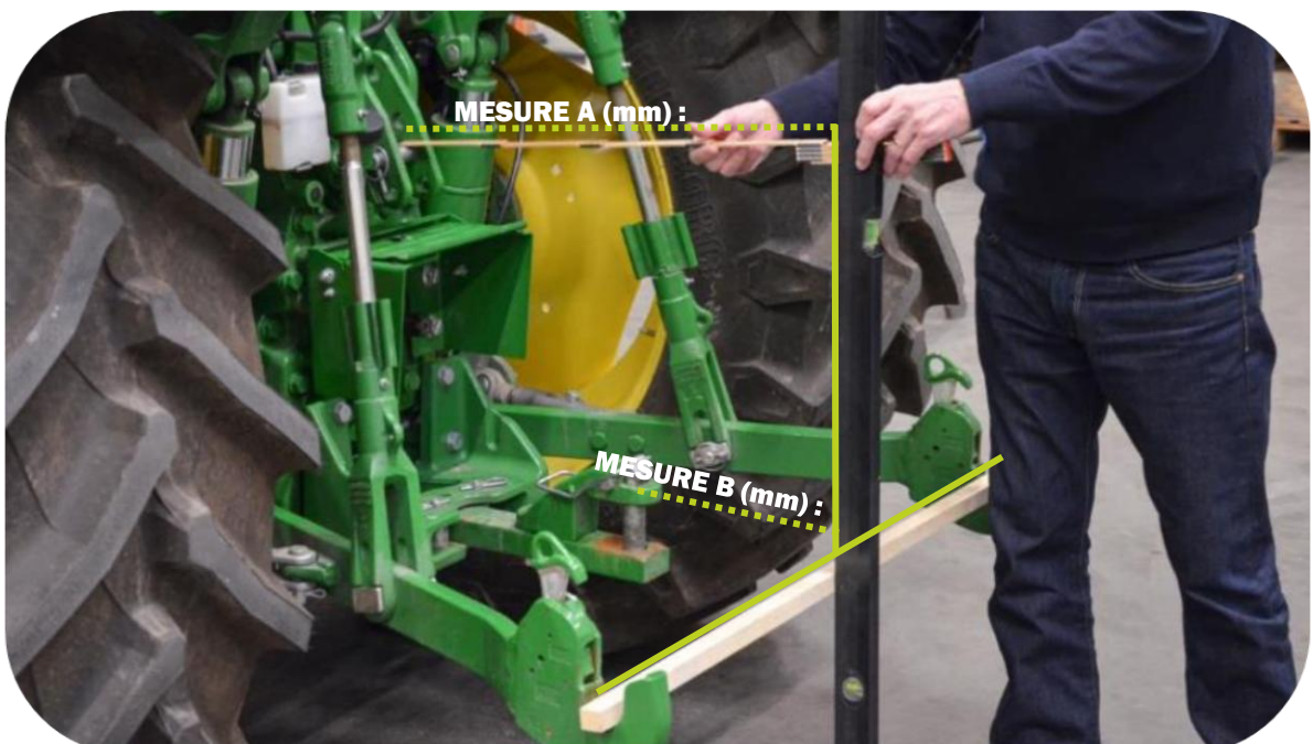
Mesure du système d'attelage à 4 points sur le véhicule : mesure « A » (en haut) et mesure « B »
