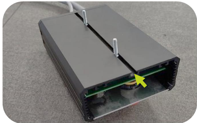
Fente pour vis de réglage en acier à l'arrière du panneau de contrôle
