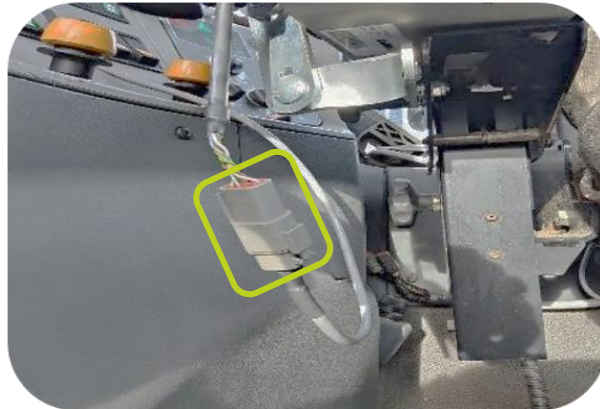
Connexion du joystick à l'aide d'une fiche/câble au panneau de commande
