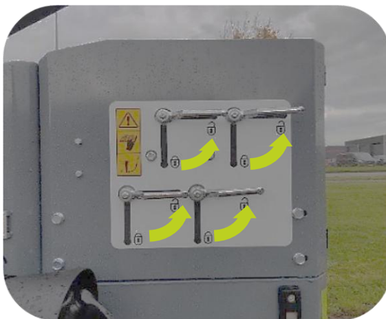
4 vannes de blocage pour le transport sur l'épareuse
