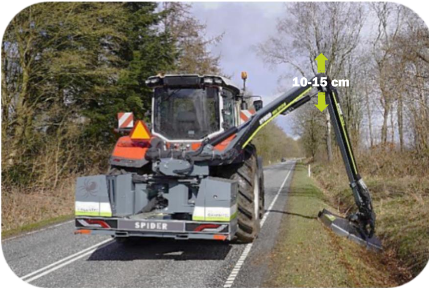
Rijden met hydraulische zweeffunctie (arm) op Spider 5-820 Plus
