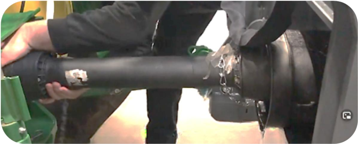
Installatie van aftakas tussen Spider 5-820 Plus armmaaier en voertuig
