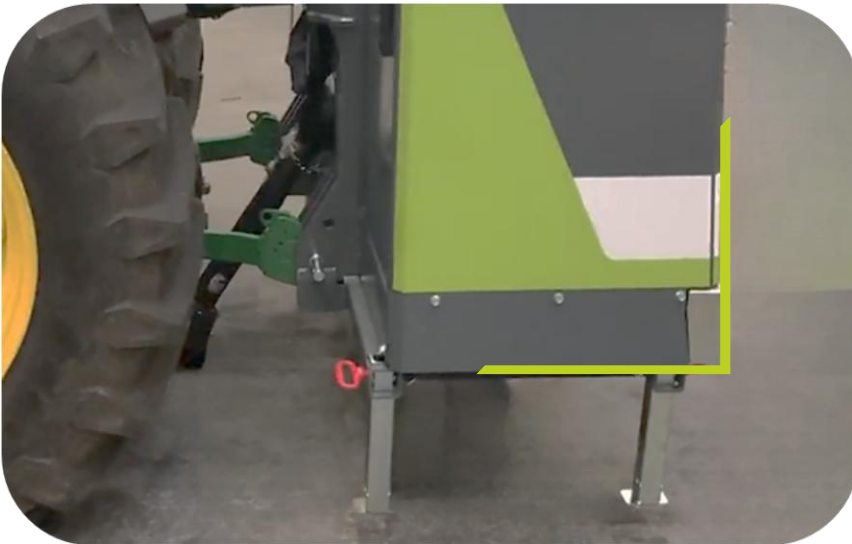
Spider 5-820 Plus geheven door de hefarmen van het voertuig in verticale positie, na juiste instelling en afstelling
