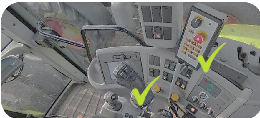
Bedieningspaneel en joystick gemonteerd en geïnstalleerd in de cabine van het voertuig
