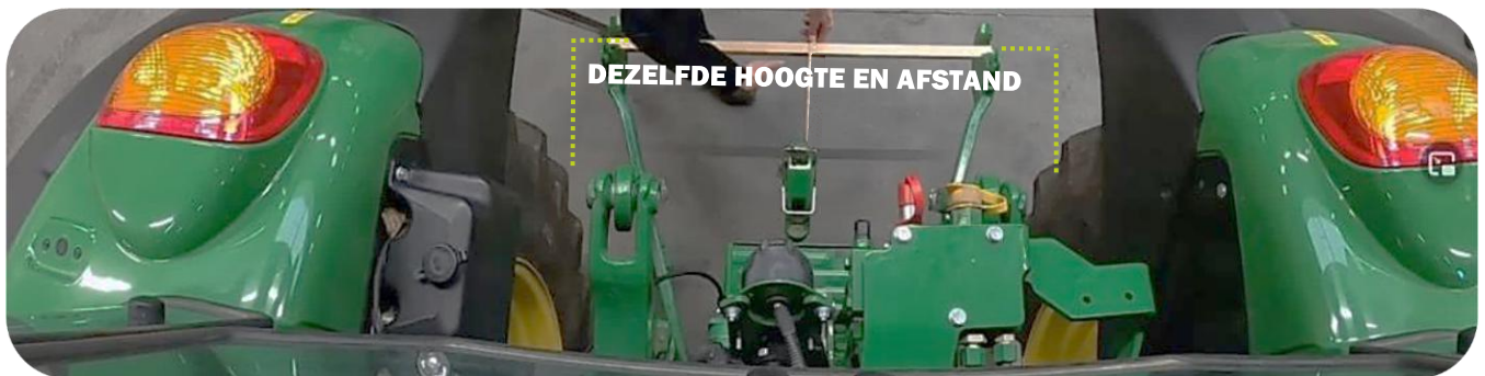
De hefarmen van het voertuig op dezelfde hoogte en afstand instellen
