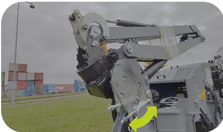
Mechanische snelkoppeling voor hulpstukken op een Spider 5-820 Plus armmaaier
