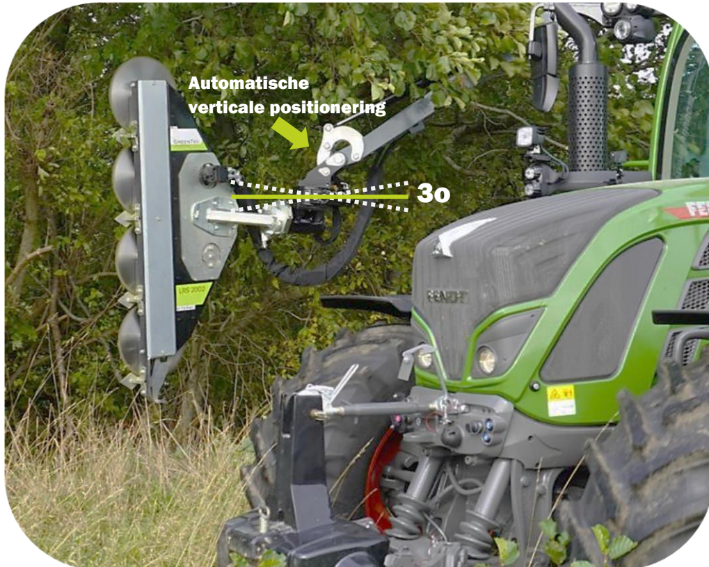
Rijden met de AutoFlex functie (automatische verticale positionering) geactiveerd: Spider 5-820 Plus
