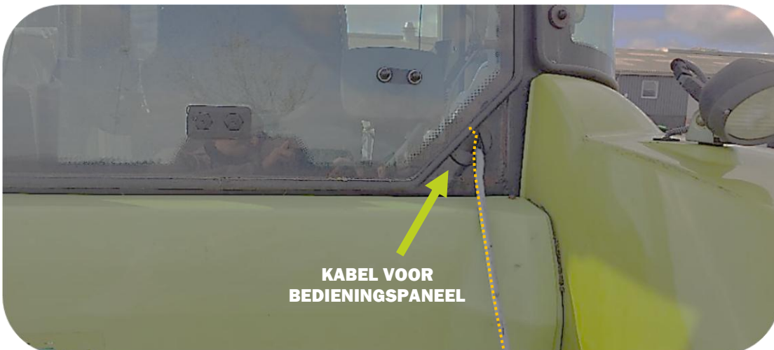
Kabelgeleiding van de armmaaier naar de cabine van het gebruikte voertuig
