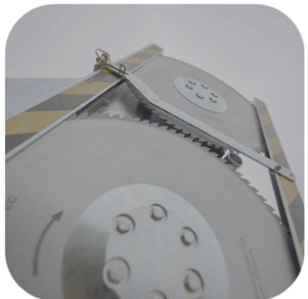
Spider 5-820 Plus armmaaier en LRS 1402 Quadsaw (achterop gemonteerd): Veiligheidsafscherming gemonteerd op zaagbladen
