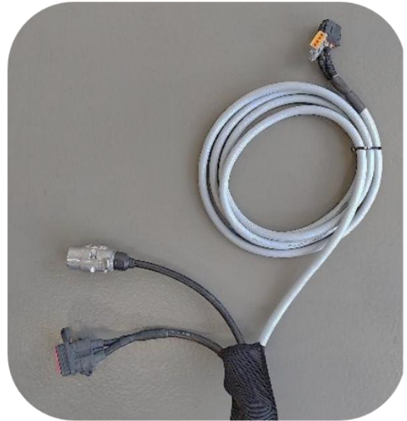
Aansluitingen (3 stuks) van Spider 5-820 Plus armmaaiers naar het voertuig
