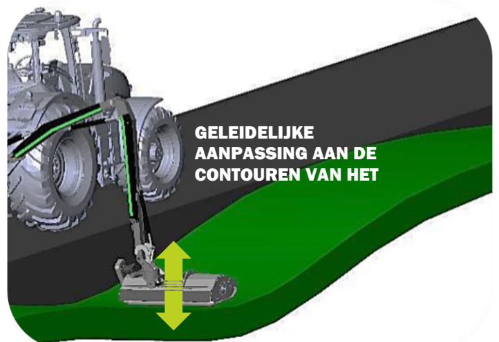
AHC (Automatische Hoogteregeling) op een Spider 5-820 Plus armmaaiër (optionele onderdelen)
