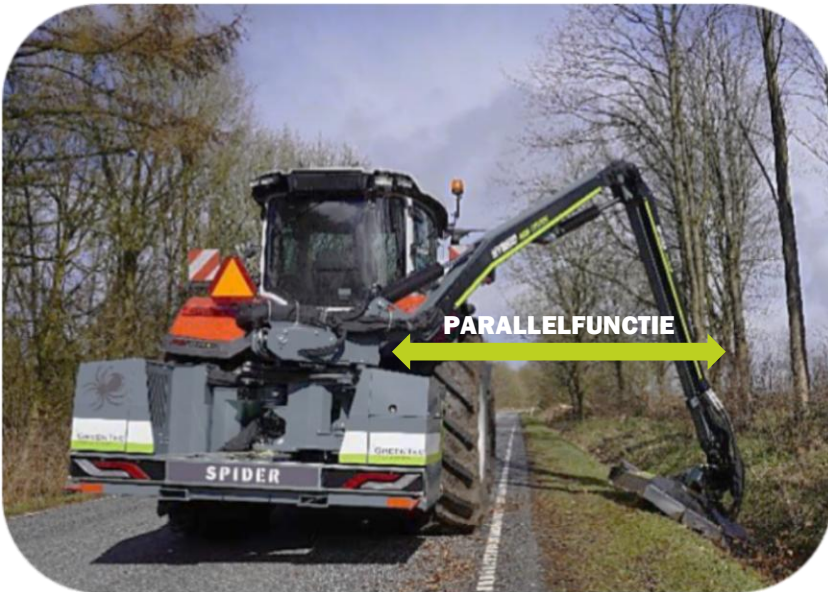
Spider 5-820 Plus armmaaier in gebruik met parallelfunctie geactiveerd
