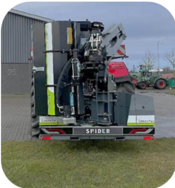
Voorbeeld van transportstand: Spider 5-820 Plus armmaaier en FR 92 klepelmaaier (achterop gemonteerd): Alle lichten vrij op de maaier en het voertuig
