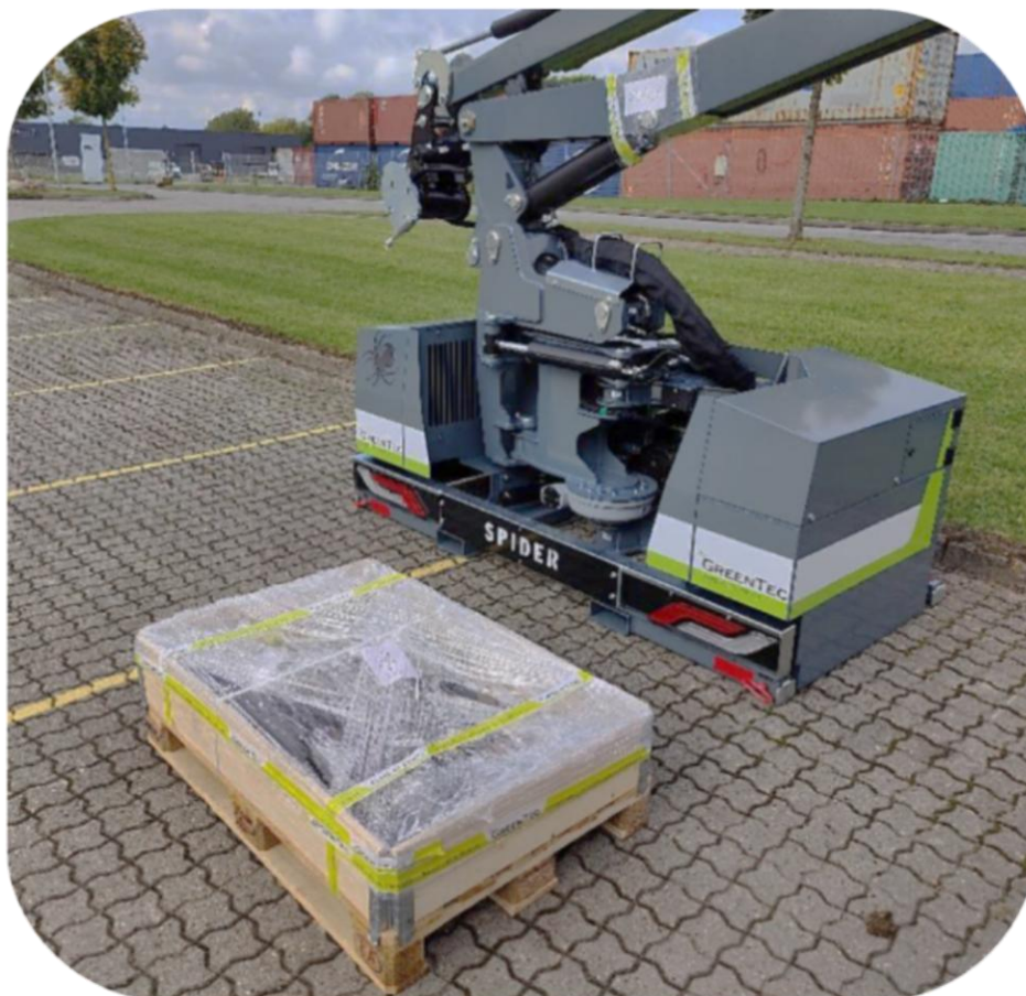
Spider 5-820 Plus armmaaier zoals geleverd vanaf de fabriek incl. transportpallet met diverse losse onderdelen
