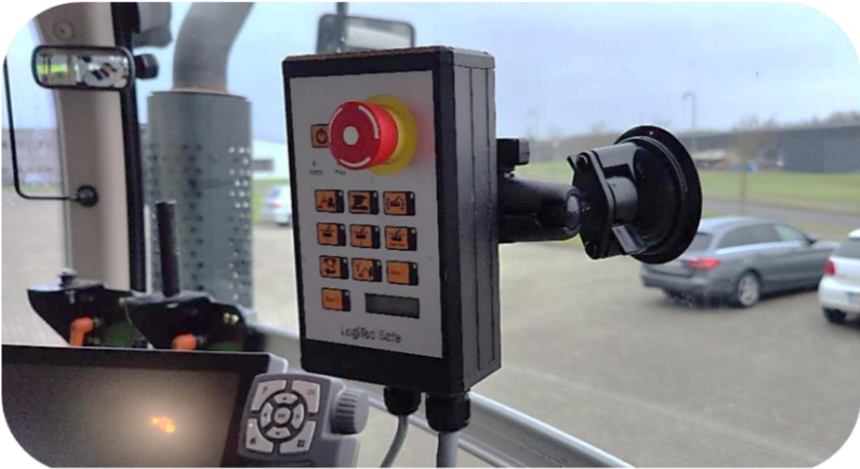
Bedieningspaneel gemonteerd in de cabine van een voertuig met Ram-mount
