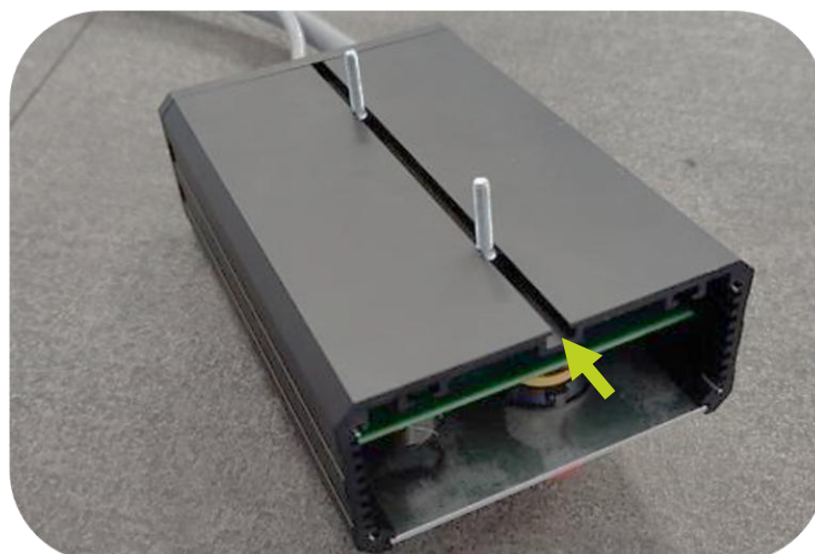
Uitsparing voor stalen stelschroeven aan de achterkant van het bedieningspaneel
