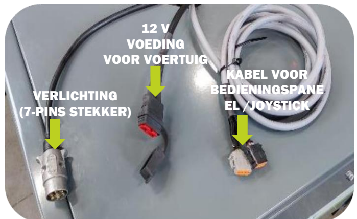
Stroom aansluiten op de armmaaier - 3 soorten verschillende kabels
