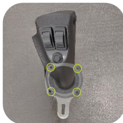
De montagebeugel (deel 1) aan de onderkant van de joystick bevestigen
