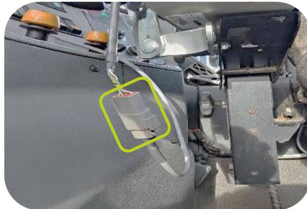
Aansluiting van joystick met 1 stekker/kabel vanaf bedieningspaneel
