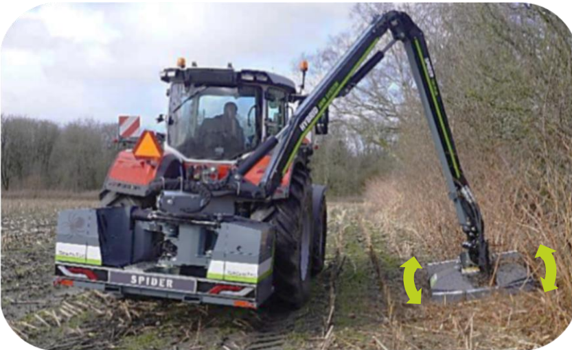
Rijden met hydraulische zweefstand functie (hulpstuk) op Spider 5-820 Plus
