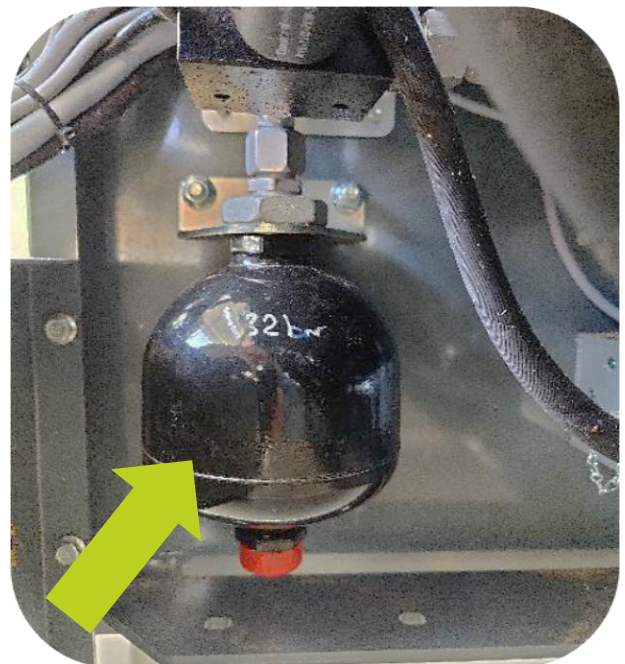
Accumulator (32 bar) op Spider 5-820 Plus armmaaier
