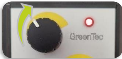
AHC-potentiometer op bedieningspaneel: ingeschakeld en afgesteld
