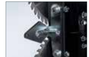
Ast-/Zweig-Führer an jedem Sägeblatt
