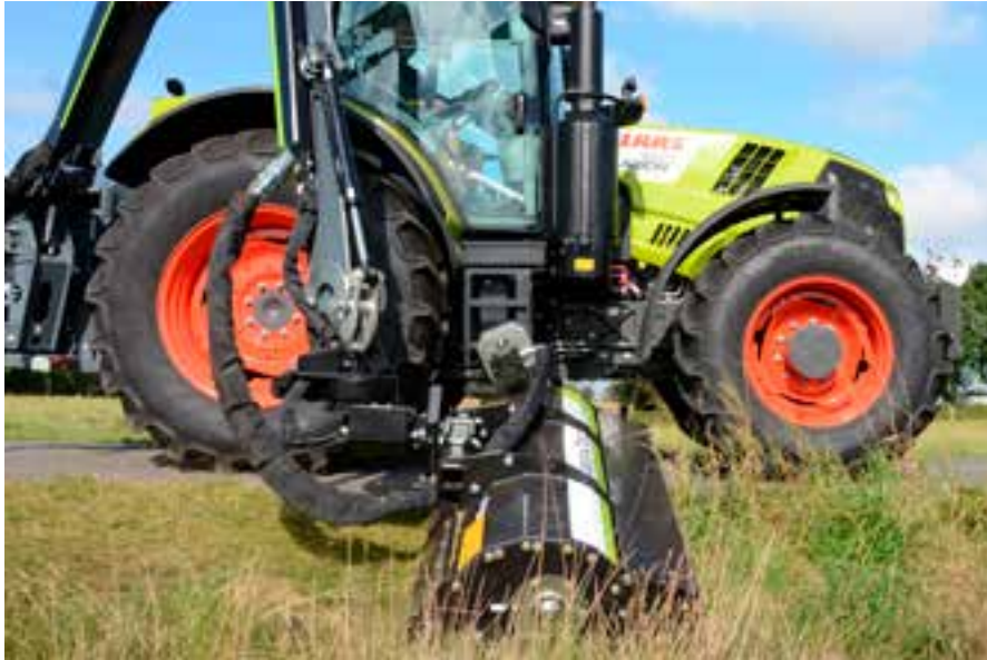
Mit dem Rotor Flex ist der Schneidekopf immer im Blickfeld (Standard in der PLUS-Serie).
