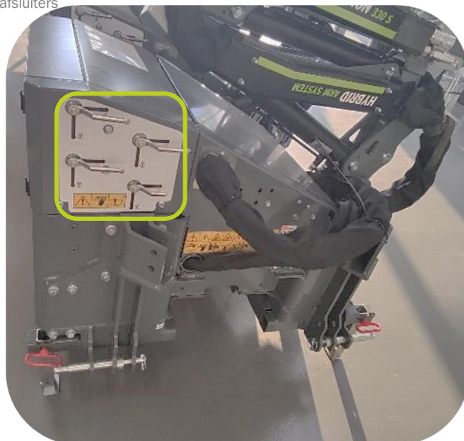
Plaats van transportvergrendelingen / stopkranen op de Scorpion 3-430
