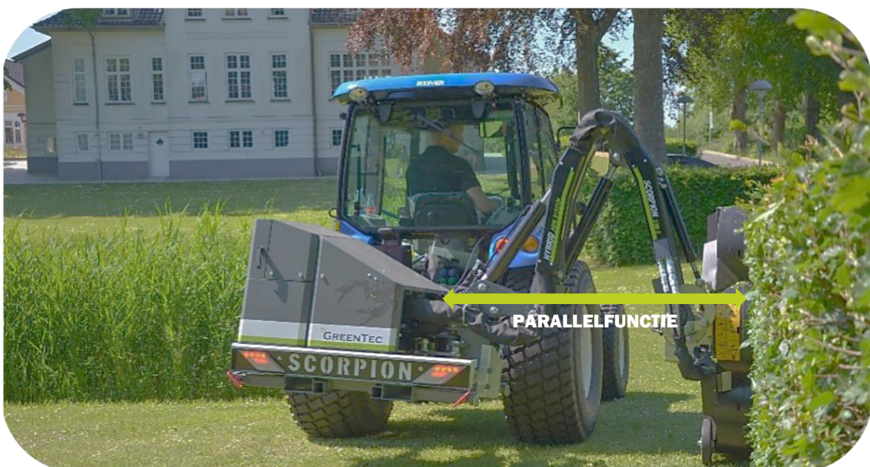
Scorpion 3-430 armmaaier in gebruik met parallelfunctie geactiveerd
