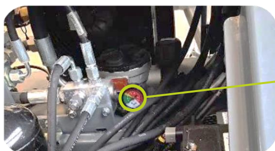
Manometer/indicator voor het vervangen van het retour oliefilter
