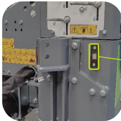
Plaats van de oliepeilmeter op de Scorpion 3-430 armmaaier
