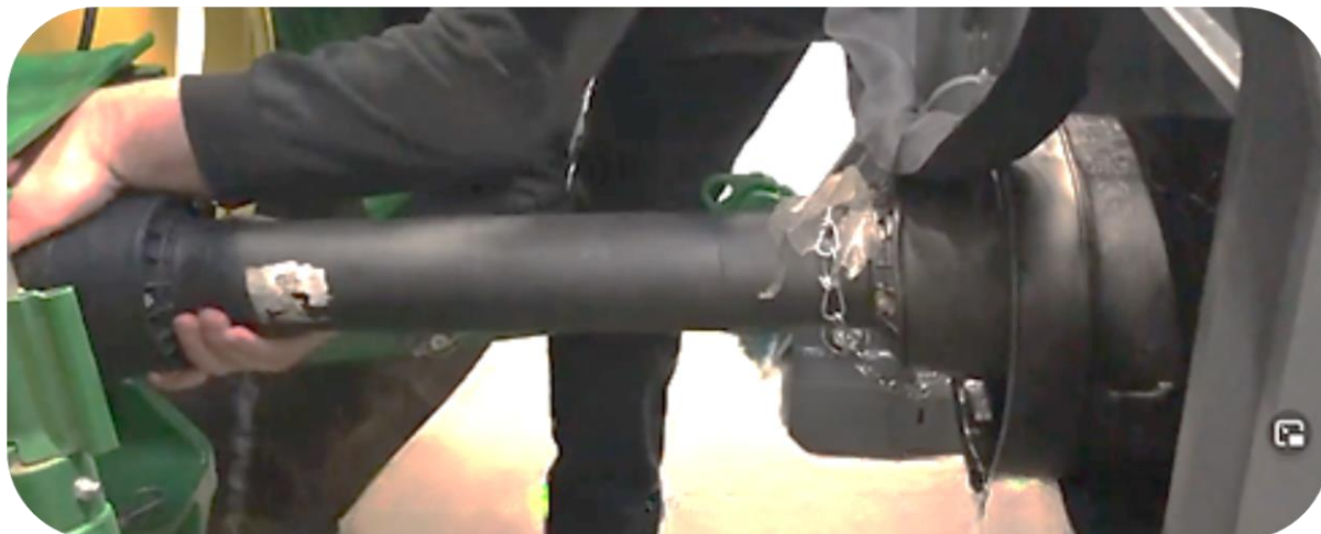
Installatie van aftakas tussen Scorpion 3-430 armmaaier en voertuig
