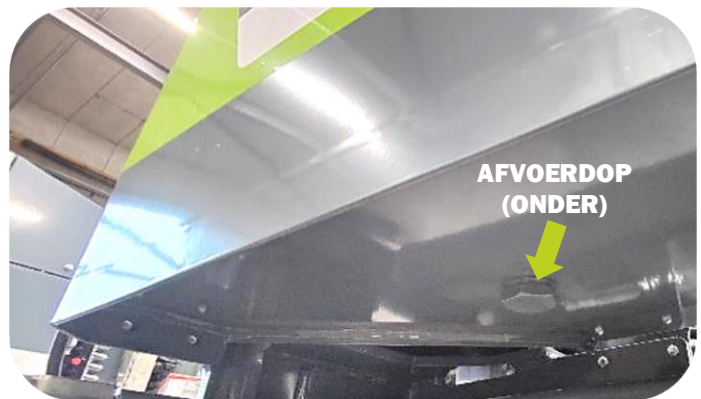
Afvoerdop voor olietank op Scorpion 3-430 armmaaier
