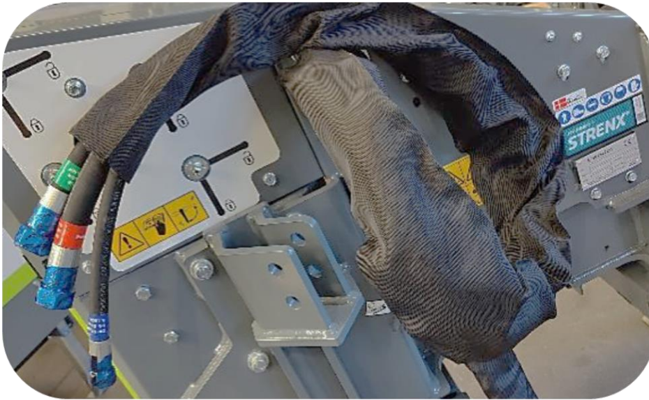
Hydraulische slangen van de Scorpion 3-430 Basic armmaaier naar het voertuig
