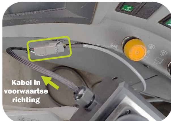
Aansluiting van joystick met 1 stekker/kabel vanaf bedieningspaneel
