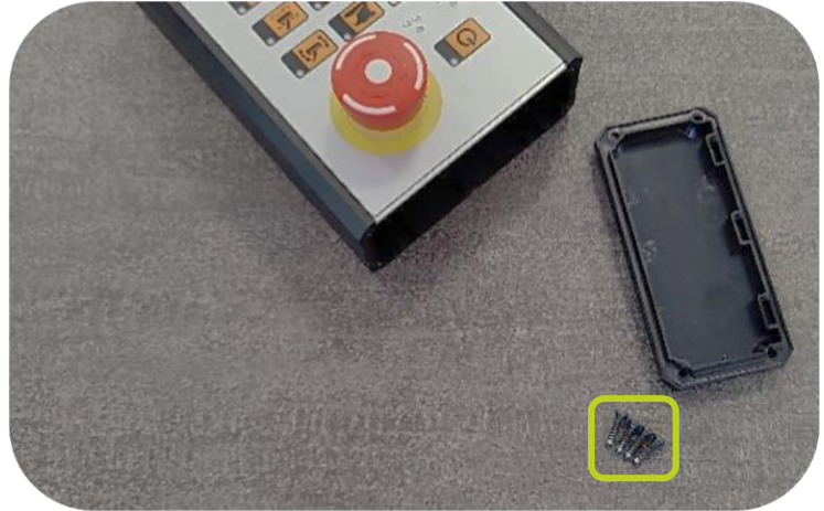
Eindplaat verwijderd van bedieningspaneel
