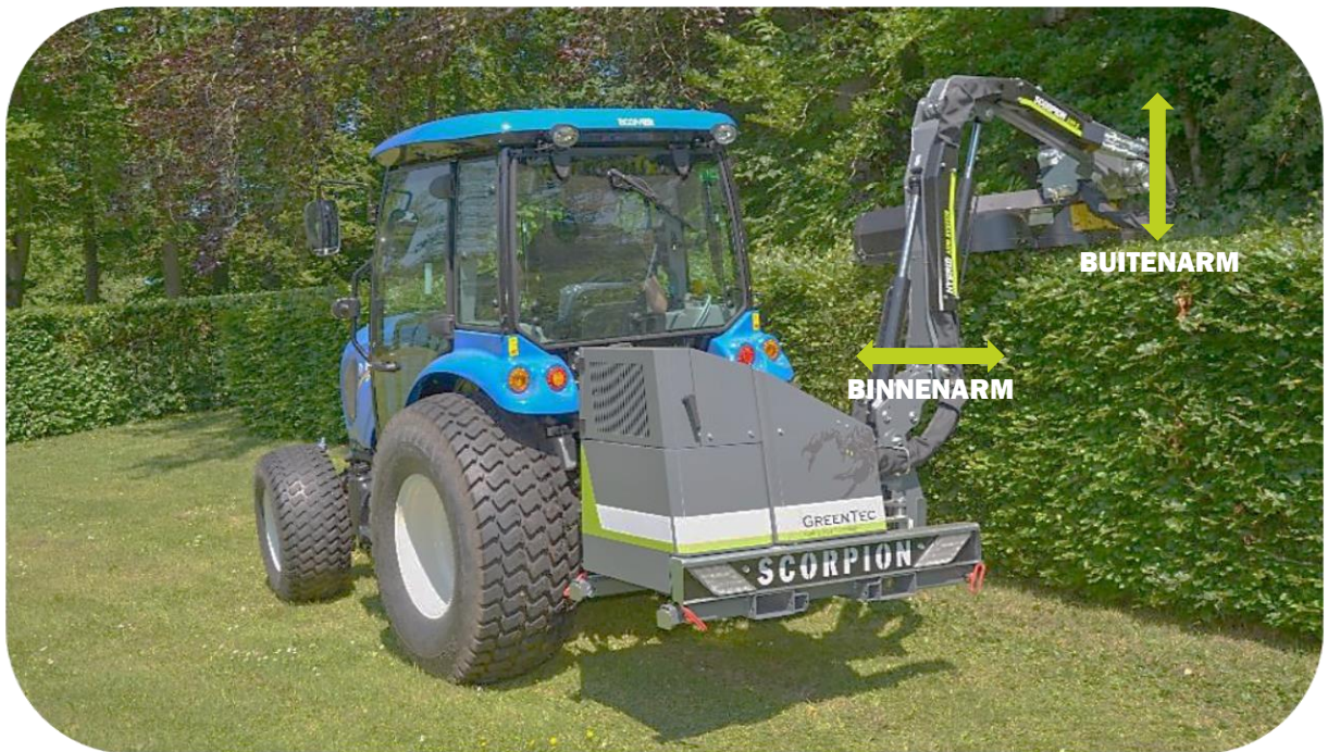
Scorpion 3-430 armmaaiër in gebruik met niet-parallelfunctie geactiveerd
