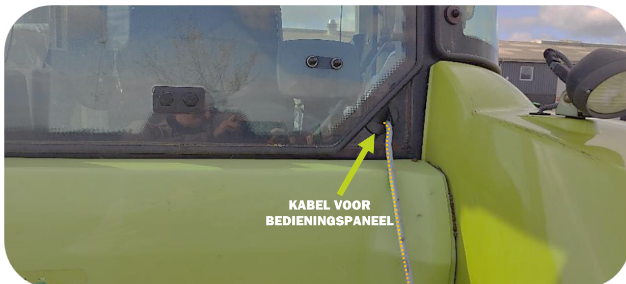
Kabelgeleiding van de armmaaier naar de cabine van het voertuig
