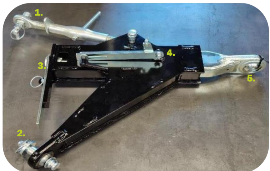
Bovenbalkbevestiging voor 4-punts montage op Scorpion 3-430 armmaaier
