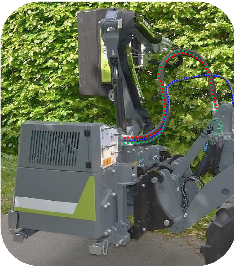
Hydraulische verbindingen tussen Scorpion 3-430 Basic model en voertuig
