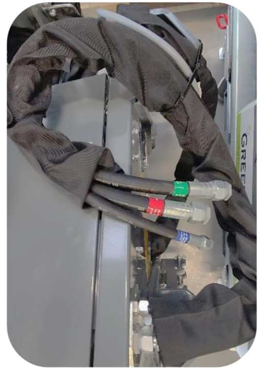
Hydraulische slangen (druk, retour en afvoer) op de Scorpion 3-430 armmaaier
