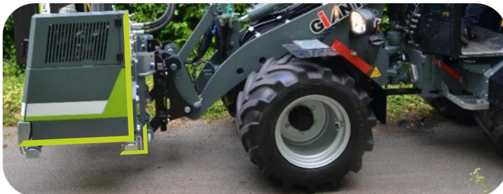
Scorpion 3-430 Basic opgetild en gemonteerd met nekbevestiging op voertuiglift in verticale positie
