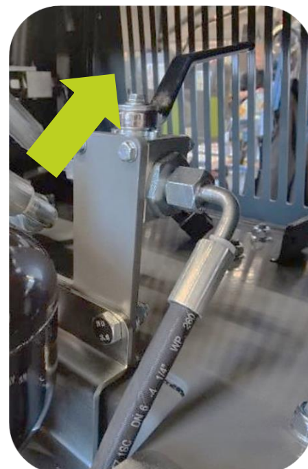
Afsluitklep (1x) voor het schakelen van werktuigen
