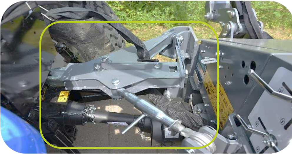
4-punts montage met behulp van 4-punts hefinrichting systeem met bovenbalkbevestiging
