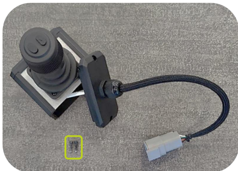
Eindplaat met kabel losgekoppeld van joystick
