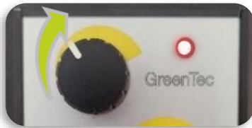
AHC-potentiometer op bedieningspaneel: ingeschakeld en afgesteld
