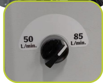
Schakelaar voor het veranderen van de olietoevoer naar het hulpstuk: 50 of 85
