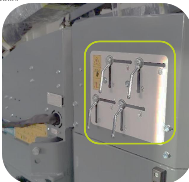
Plaats van transportvergrendelingen / stopkranen op de Scorpion 5-830
