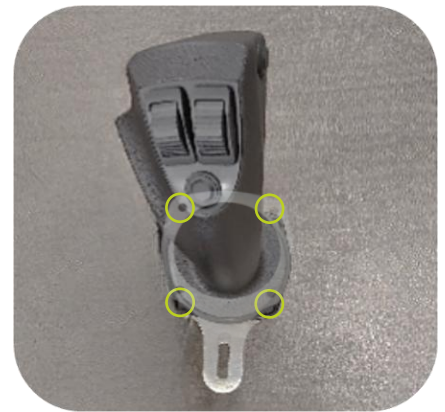
De montagebeugel (deel 1) aan de onderkant van de joystick bevestigen
