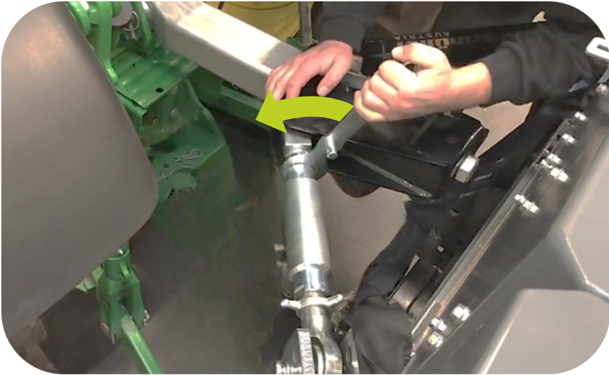
Afstelling van de dwars bovenste trekstang voor het spannen van de stabilisatie tussen voertuig en armmaaier
