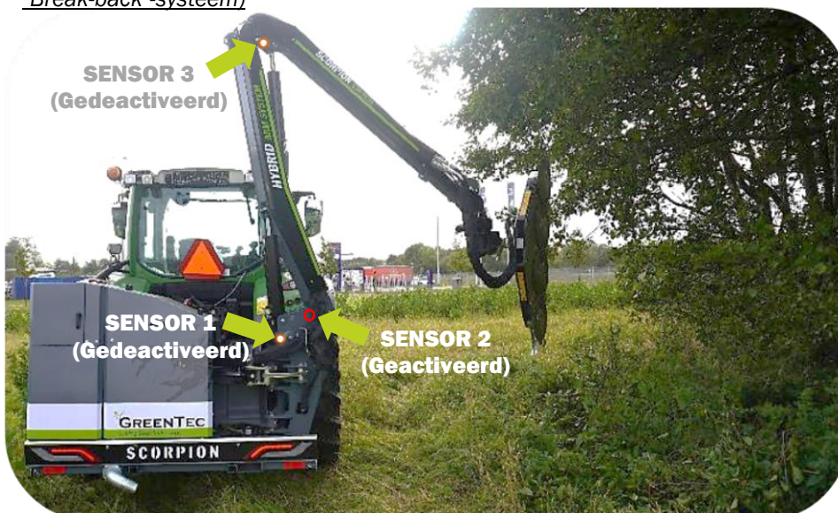
Veiligheidssensor 2 is geblokkeerd en hierbij geactiveerd: Scorpion 5-830 armmaaier
