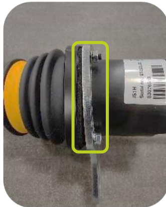
De montagebeugel (deel 1) aan de onderkant van de joystick bevestigen
