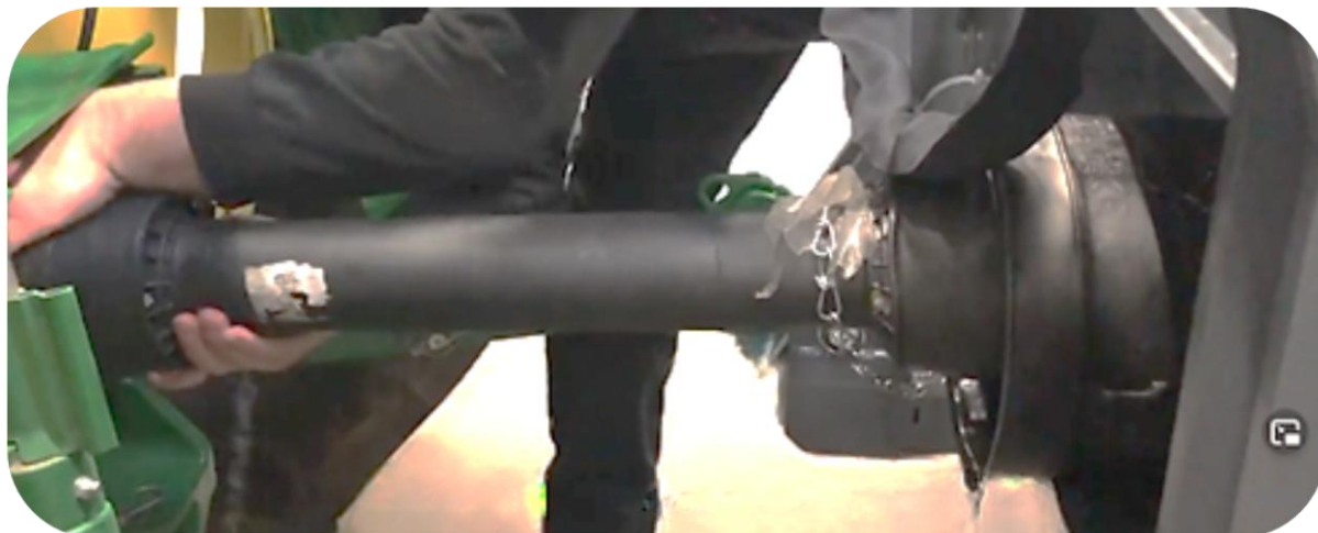
Installatie van aftakas tussen Scorpion 5-830 armmaaier en voertuig
