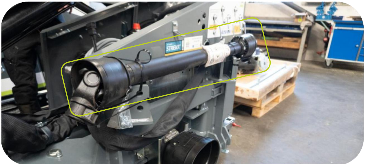
For Scorpion 490 Standard og Plus-armklippere er PTO-aksel fastspændt maskinens bagside ved levering.
