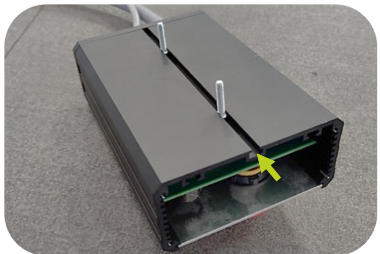
Udskæring til stålsætskrue på bagside af betjeningspanel
