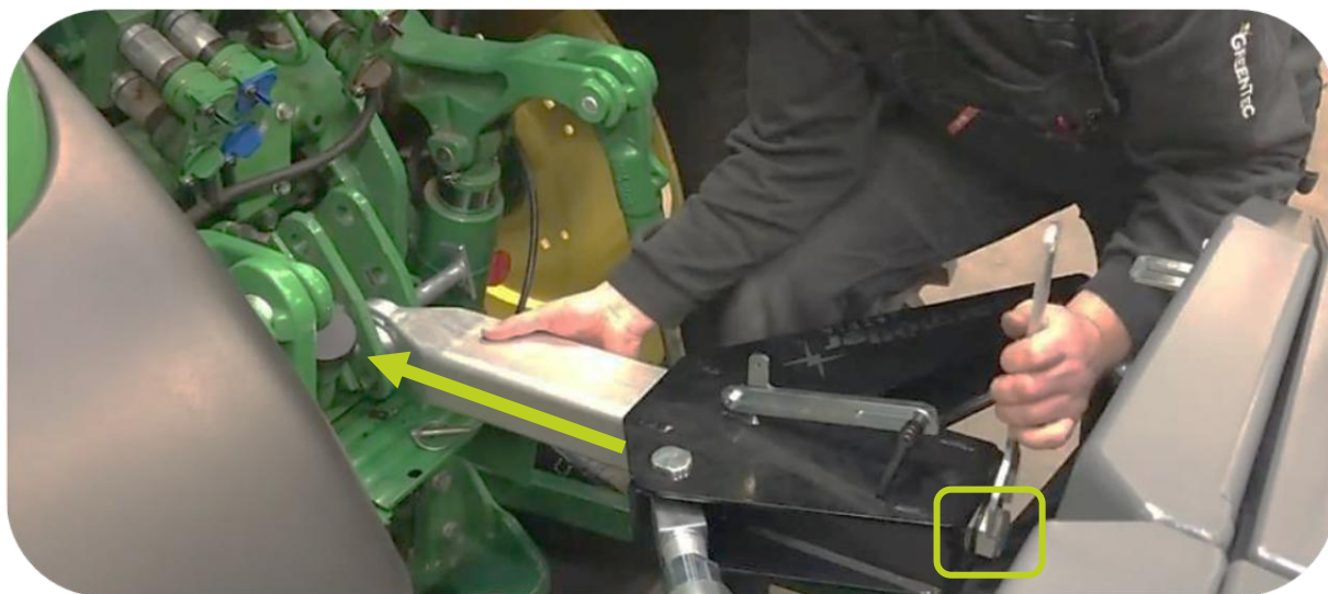
Justering af øverste stabilisering m. trækøje til køretøjets trækpunkt vha. gaffelnøgle
