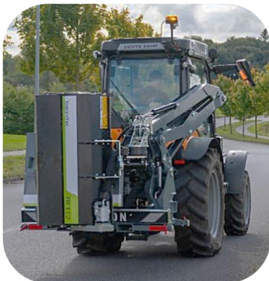
Eksempel på transportstilling: Scorpion 490 armklipper og FR Slagleklipper (bagmonteret): Alle lygter fri på armklipper og køretøj
