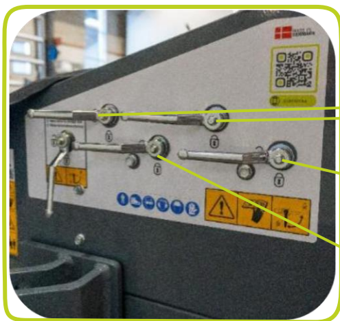
Spærrehaner (4 stk) for cylinderblokering/transportstilling, samt 1 for redskabsskift
