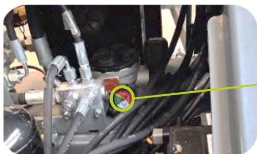
Manometer/indikator for skift af returfilter
