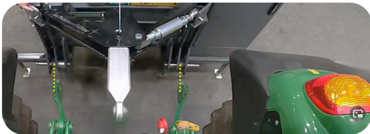
Køretøjet bakkes forsigtigt op til monteringspunkterne på Scorpion 3-430 armklipperen
