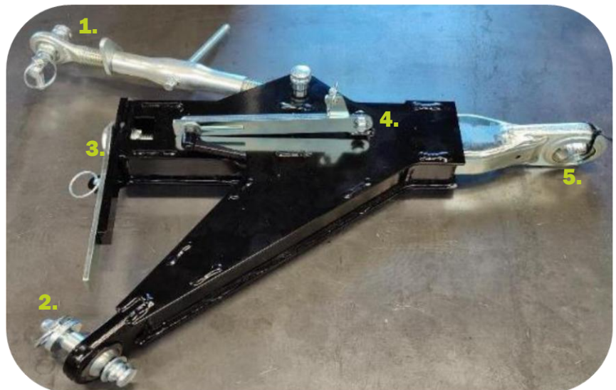
Topstangsfæstet for 4-punktsmontering på Scorpion 490-armklipper
