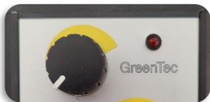
AHC-potentiometer på betjeningspanel i i "0"-position
