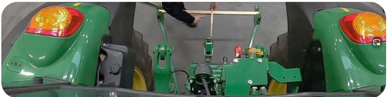
Justering af køretøjets liftarme i samme højde og afstand
