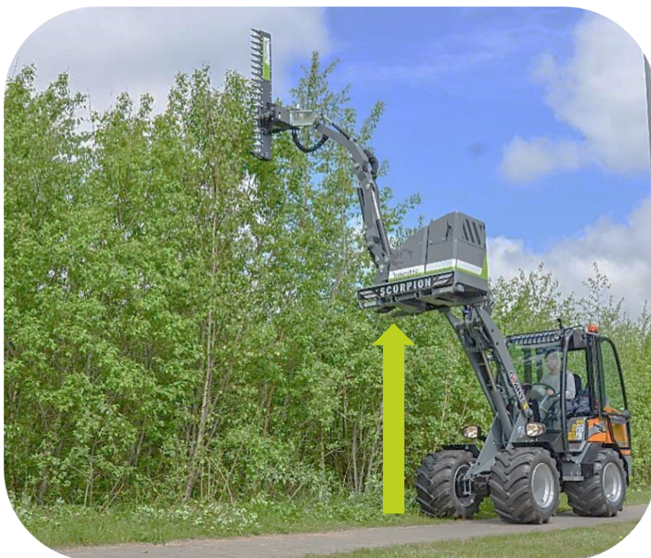
Scorpion 490 armklipper ophævet vha. frontlæsser med påmonteret HS 172 hæk- og hegnsklipper
