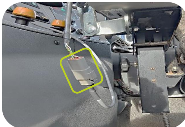
Tilslutning af joystick vha. 1 stik/kabel fra betjeningspanel
