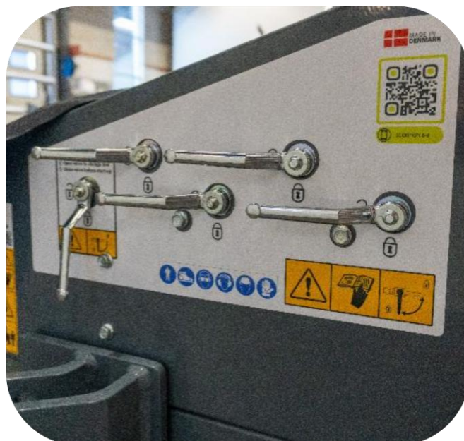
Placering af transportlåse / spærrehaner på Scorpion 490 armklipper
