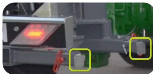
Støtteben opslået på Scorpion 490-armklipper
