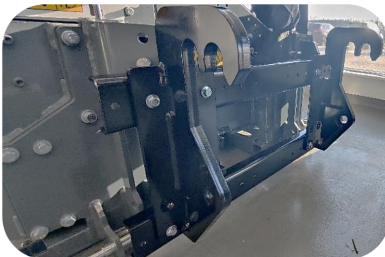
Monteringsramme og nakkebeslag monteret på Scorpion 490 armklipper ved levering
