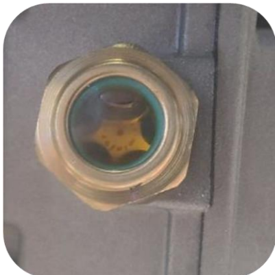
Skueglas for kontrol af gear-olieniveau på gearkasse
