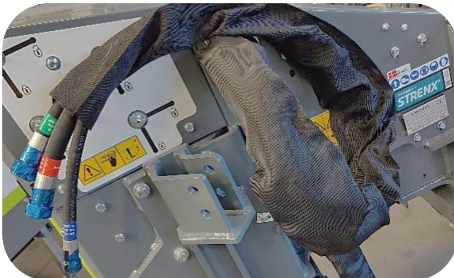
Hydrauliske slanger for tilslutning t. køretøj på Scorpion 490 Basic-armklipper
