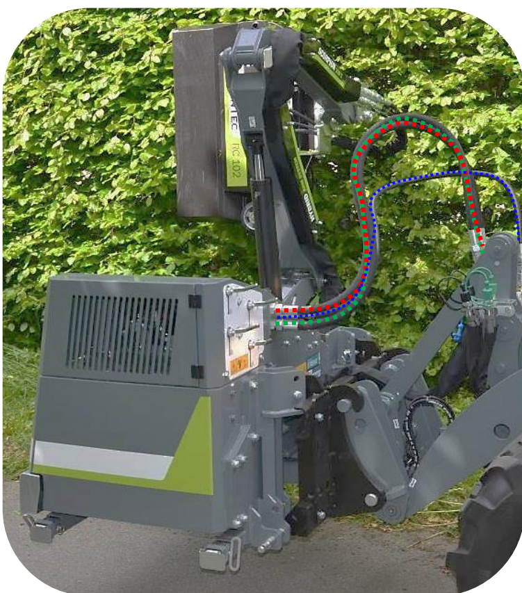
Hydrauliske tilslutninger mellem Scorpion 3-430 Basic-model og køretøj
