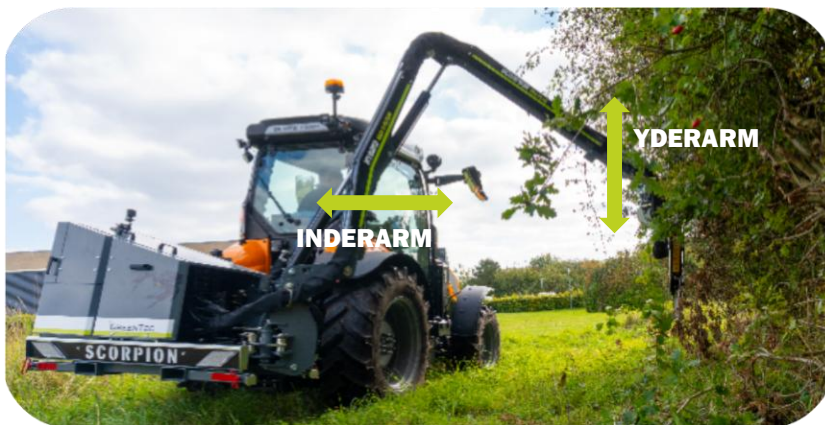
Scorpion 490 armklipper under anvendelse med non-parallelføring af armklipper
