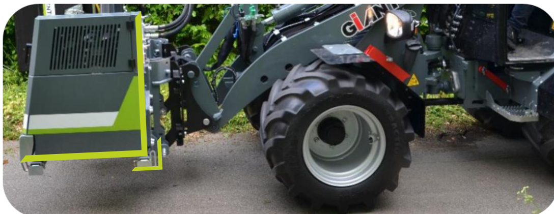
Scorpion 490 opløftet og monteret vha. nakkebeslag på køretøjets liftsystem i lodret position
