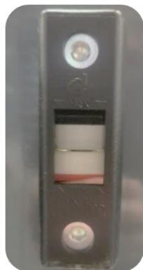
Skueglas for kontrol af hydraulikolieniveau i tank
