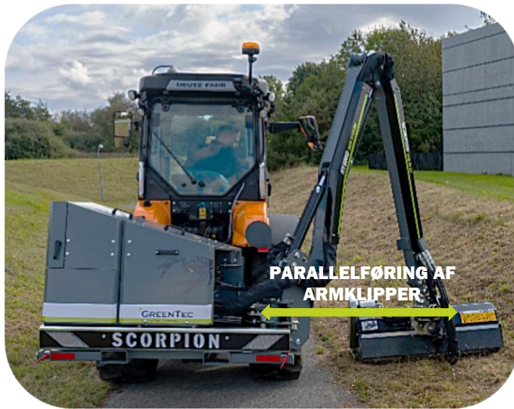
Scorpion 490 armklipper under anvendelse med parallelføring af armklipper
