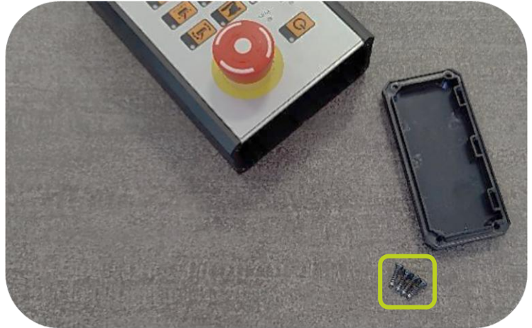
Endeplade afmonteret på betjeningspanel
