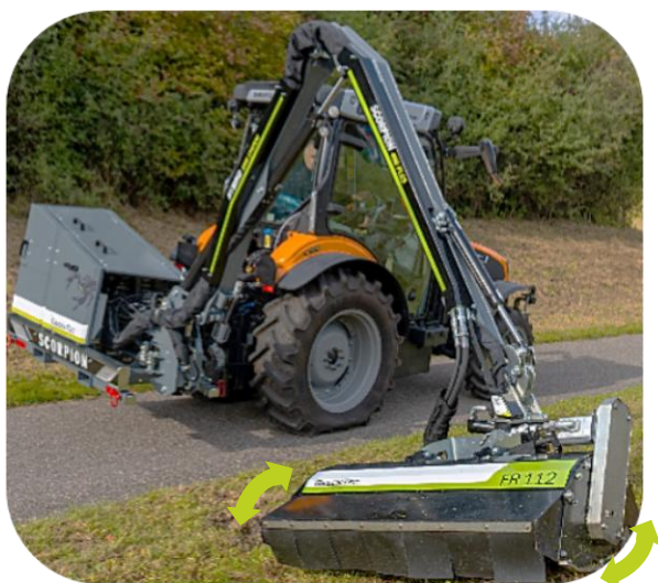
Kørsel med flydestillingsfunktion for arbejdsredskab på Scorpion 490 armklipper
