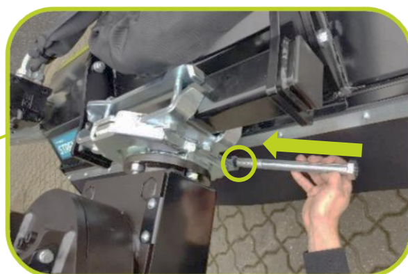
Hurtigskifte låses altid fast med medfølgende lang låsebolt og ringsplit!
