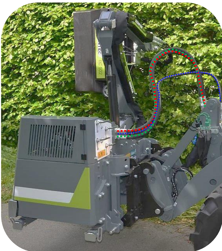
Hydrauliske tilslutninger mellem Scorpion 3-430 Basic-model og køretøj
