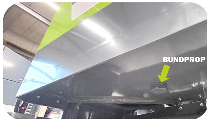
Bundprop for olietank på Scorpion 3-430-armklipper
