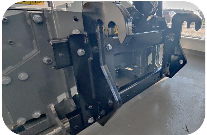
Monteringsramme og nakkebeslag monteret på Scorpion 490 armklipper ved levering
