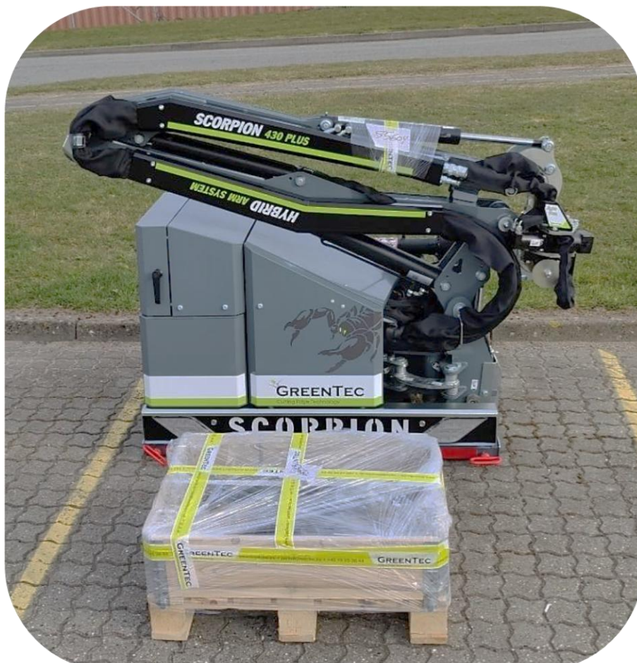
Scorpion 490 armklipper som den leveres fra fabrikken inkl. transportpalle m. diverse løsdele
