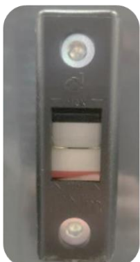
Skueglas for kontrol af hydraulikolieniveau i tank
