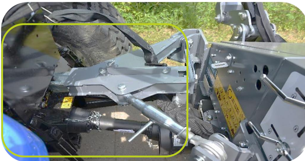
4-punkts montering vha. 4-punktsophæng med topstangsfæste: Scorpion 490 armklipper
