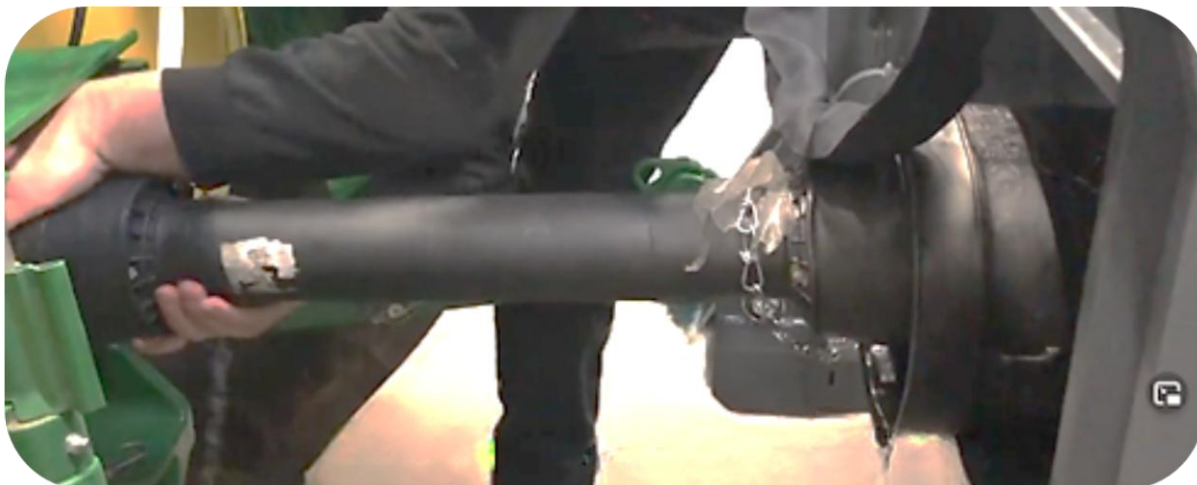
Montering af PTO-aksel imellem Scorpion 490 armklipper og køretøj
