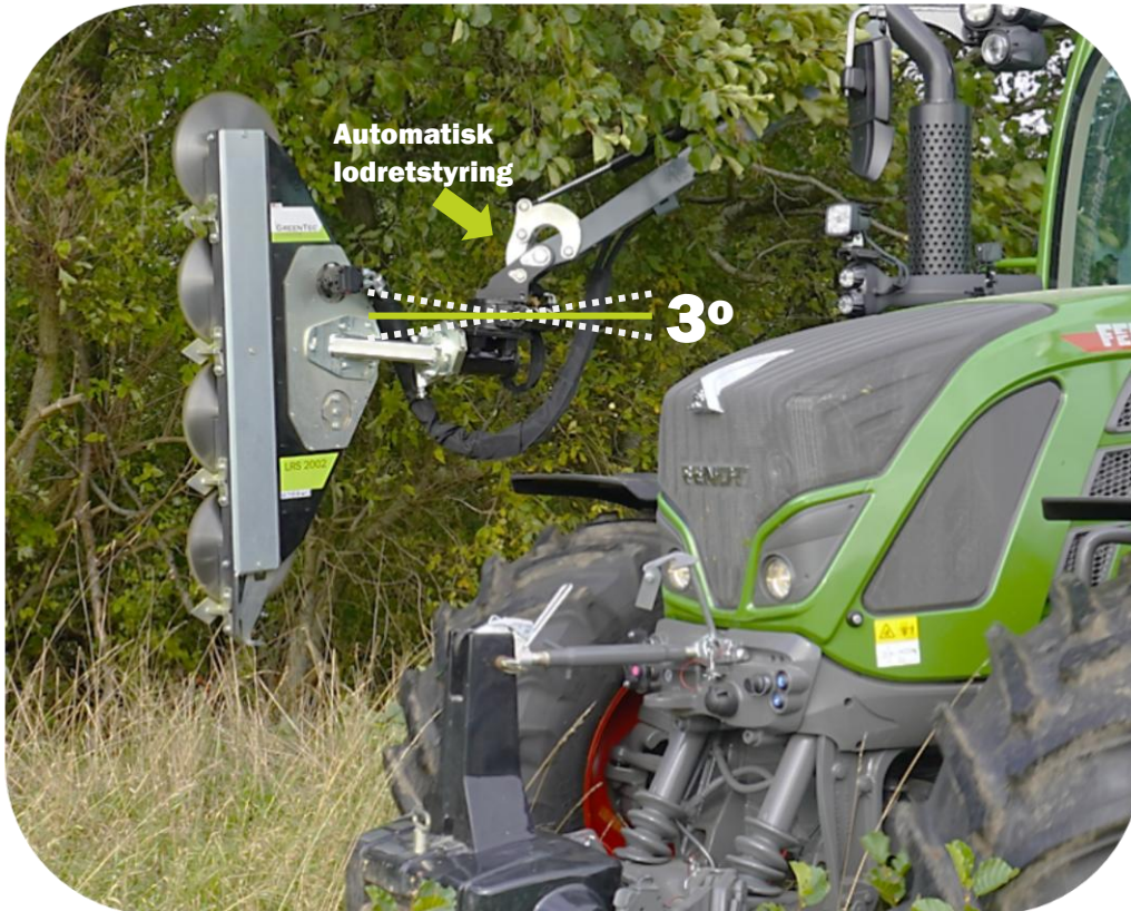
Kørsel med AutoFlex-funktionen (Automatisk lodretstyring) aktiveret: Scorpion 490 armklipper
