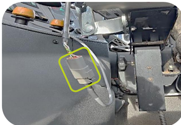
Tilslutning af joystick vha. 1 stik/kabel fra betjeningspanel
