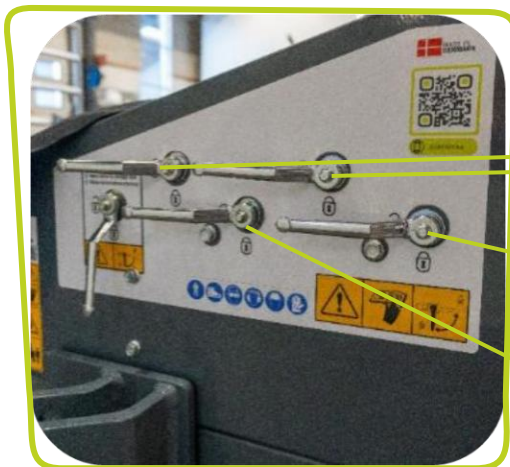
Spærrehaner (4 stk) for cylinderblokering/transportstilling
