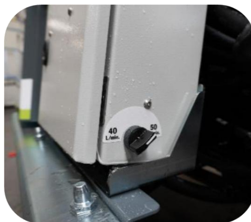
Kontakt for skift af oliefor- syning til arbejdsredskab: 40 ell. 50 l/min.
