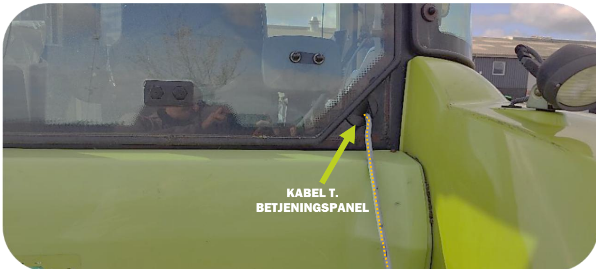
Indføring af kabel fra armklipper til kabinen på det anvendte køretøj
