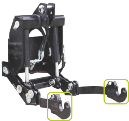
Standard hydraulisk liftarmsystem på køretøjer
