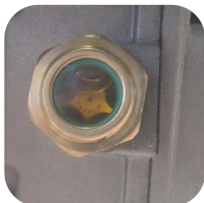
Skueglas for kontrol af gear-olieniveau på gearkasse
