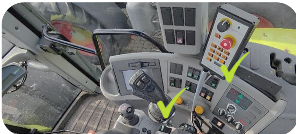
Betjeningspanel og joystick monteret og installeret i kabine på køretøj
