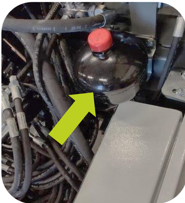
Akkumulator (32 bar) på Scorpion 490 armklipper
