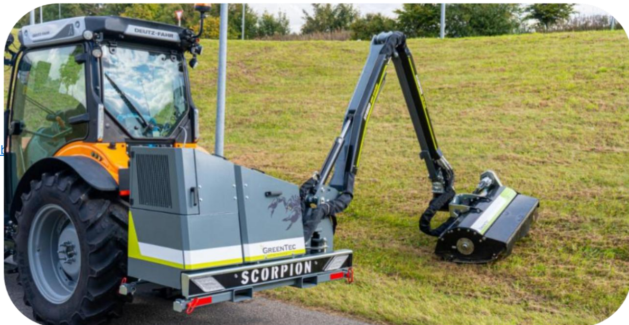
GreenTec Scorpion 490 armklipper: bagmonteret på kompakttraktor
