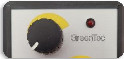
AHC-potentiometer på betjeningspanel i i "0"-position
