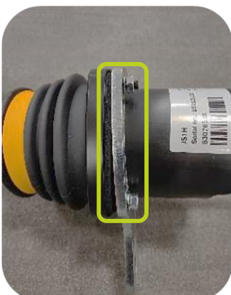
Fastgørelse af monteringsbeslag (del 1) på underside af joystick
