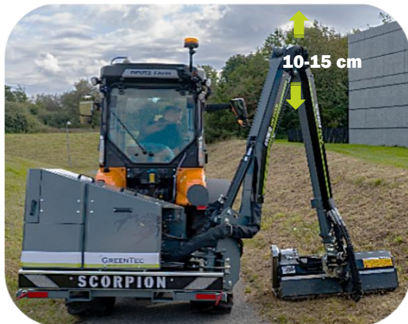
Kørsel med flydestillingsfunktion for arm på Scorpion 490 armklipper
