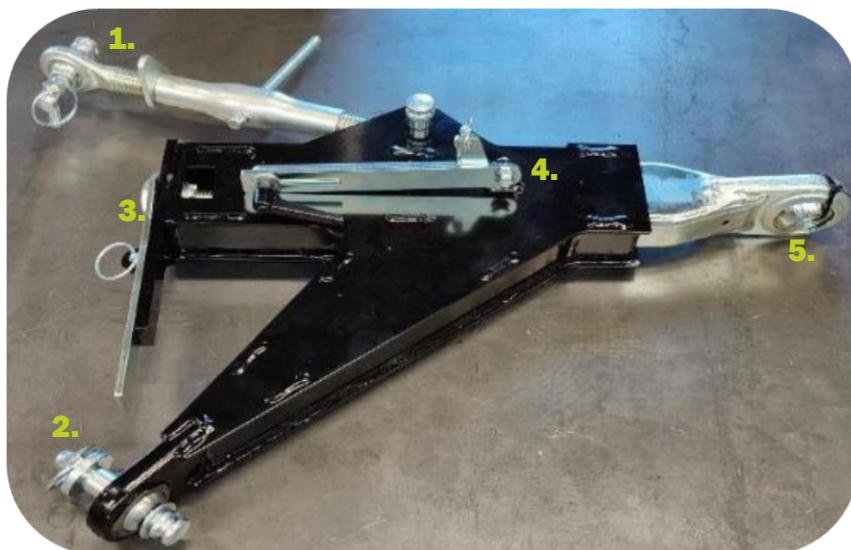
Topstangsfæstet for 4-punktsmontering på Scorpion 490-armklipper
