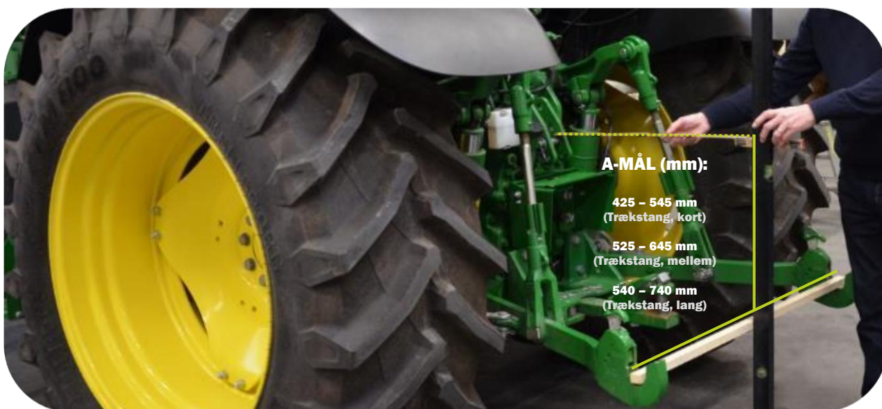
Udmåling af "A-mål" på køretøj i fbm. montering med det øverste topstangsfæste på Scorpion 490 armklipper
