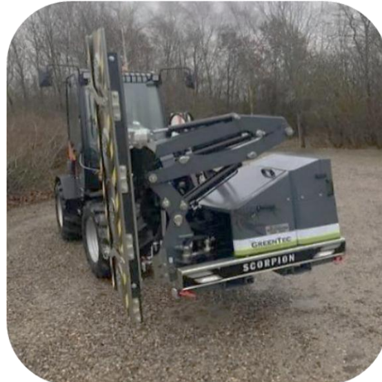
Eksempel på transportstilling: Scorpion 490 armklipper og LRS Grensav (frontmonteret): Sikkerhedsanordning monteret på savklinger
