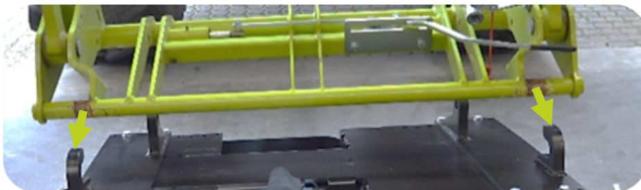
Eksempel på køretøjets liftsystem med nakkebeslag tilpasset hertil.
