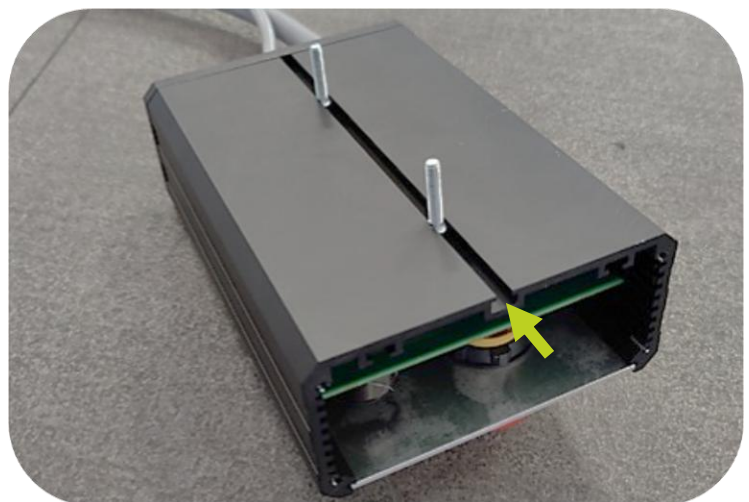
Udskæring til stålsætskrue på bagside af betjeningspanel
