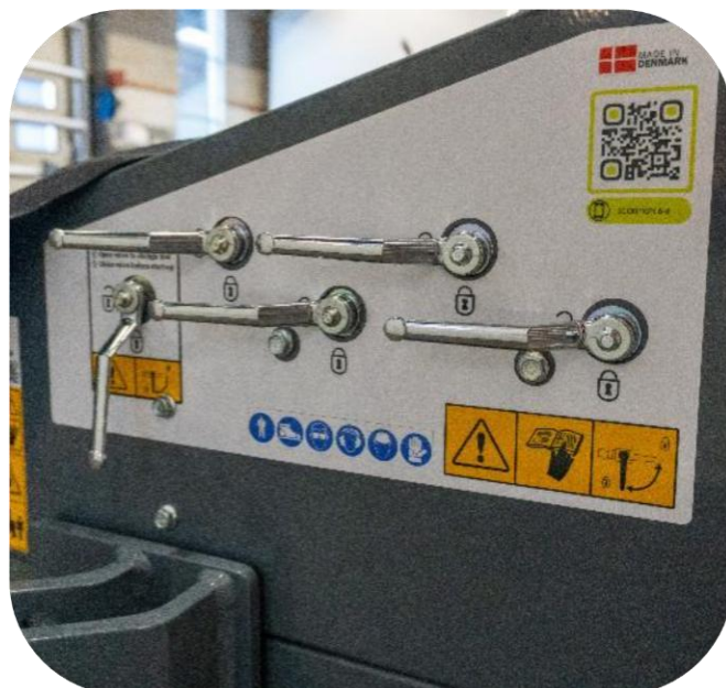
Placering af transportlåse / spærrehaner på Scorpion 490 armklipper
