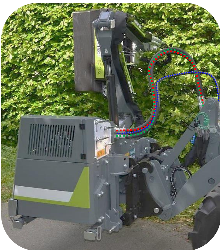
Hydraulic connections between Scorpion 3-430 Basic-model og køretøj
